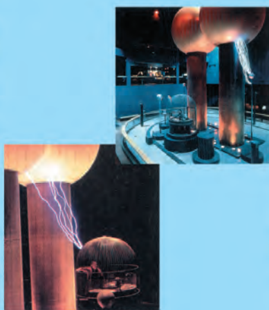
شکل بالا یک مولد و آن دو گراف را در موزه علوم پرستون نشان می دهد. این مولد یک تخلیه الکتریکی عظیم ایجاد می کند. اما همان طور که در شکل دیده می شود شخص درون قفس فلزی (اتاناک فارادی) از اثرهای این تخلیه حفاظت شده است.
