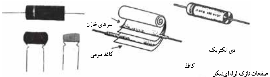
شکل ۱۵-۱۵- ساختمان و نمونه هایی از خازن های کاغذی
