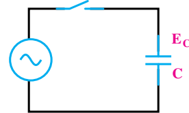
شکل ۱۶-۳- اتصال خازن به ولتاژ متناوب
