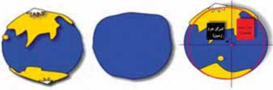
شکل ۴-۳- شکل طبیعی سطح زمین (چپ)، سطح متوسط آبهای آزاد یا ژئوئید به عنوان سطح مبنای ارتفاعی (وسط)، و بیضوی دورانی به عنوان سطح مبنای مسطحاتی (راست)
