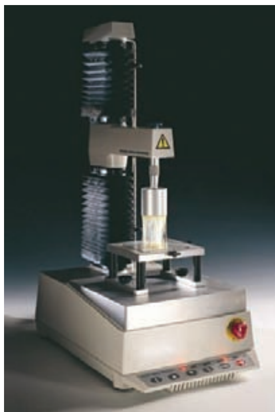
شکل ۲-۳- نمونه دیگری از یک دستگاه پیشرفته اندازه‌گیری میزان چسبندگی
