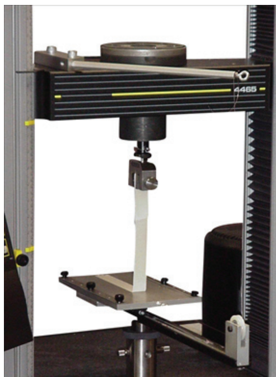
شکل ۲-۲- دستگاه پیشرفته اندازه‌گیری میزان چسبندگی انواع نوارها
