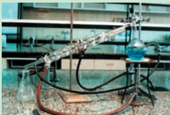
شکل ۱-۸- دستگاه معمولی تقطیر ساده
