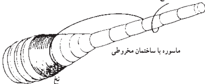
شکل ۱-۲۲- طریقه ی باز شدن نخ از روی ماسوره ی نخ بود
