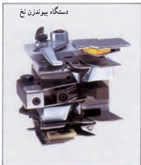
شکل ۱-۱۹- پیوند نخ در ماشین بوبین پیچی
