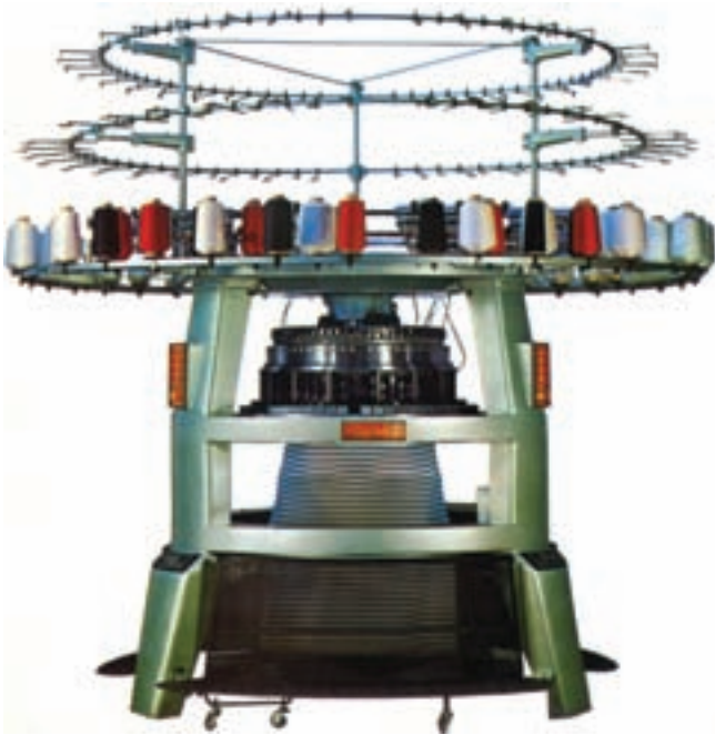
شکل ۲-۱۷- نمای یک ماشین گردباف مجهز به قفسه‌ی مدور نخ روی بدنه
