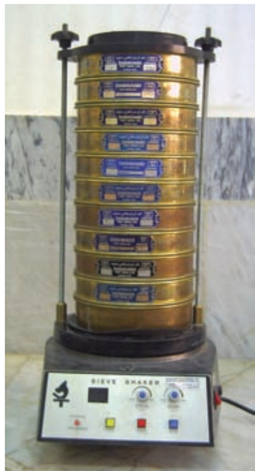
شکل ۱-۱- دستگاه لرزان آزمایشگاهی سری الک‌های استاندارد
