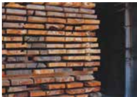
شکل ۱۵-۱ ترک انتهایی در چوب بلوط
