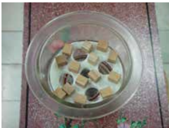
شکل ۱-۷- نمونه‌های آزمون رطوبت در داخل دسیکاتور
