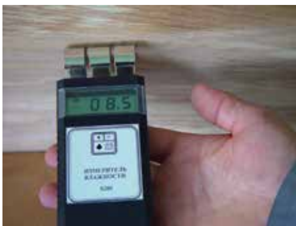
شکل ۱-۱- نوعی رطوبت سنج الکتریکی بدون الکتروود
