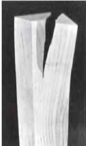
شکل ۲۶-۱- ترک برداشتن یک قطعه چوب کاج در اثر وجود چوب فشاری
