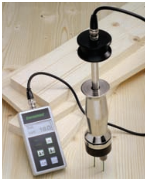
شکل ۳-۶- طرز کار با رطوبت‌سنج الکتریکی
