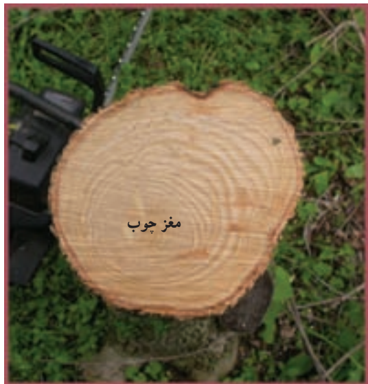
شکل ۸-۱- برش عرضی درخت پهن برگ: چوب کششی در قسمت فوقانی قرار دارد و چوب نرمال در قسمت پایین قرار دارد.
