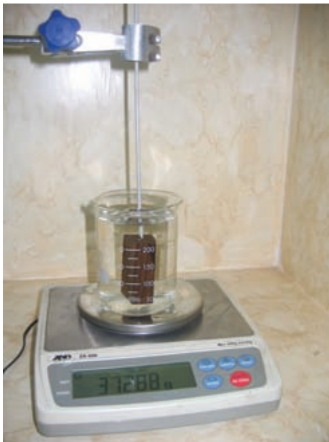
شکل ۲-۴- روش اندازه‌گیری حجم با توزین آب، قبل و بعد از فروبردن نمونه در آن
