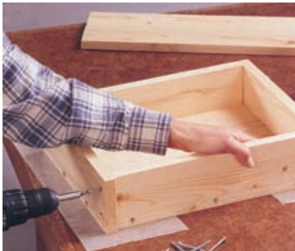
شکل ۲۲- اتصال جعبه با پیچ
