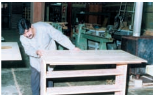
شکل ۱۷- نصب صفحه‌ی میز بر روی بدنه‌ها
