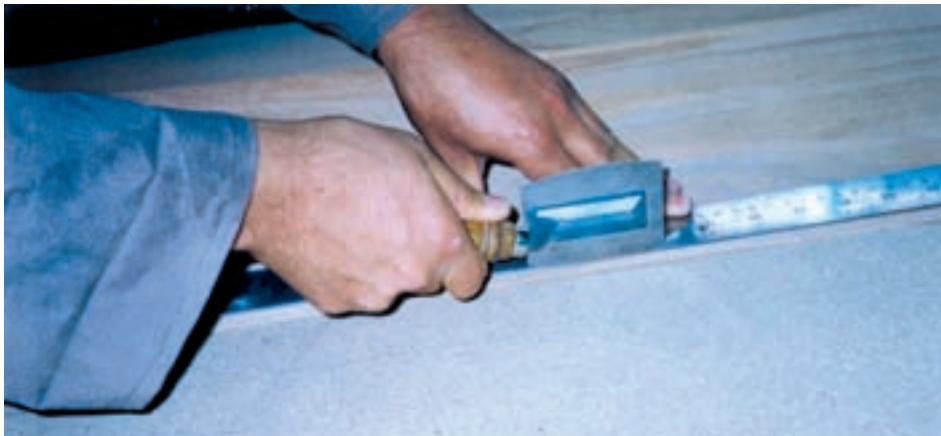
شکل ۱۷- قطع روکش به وسیله‌ی اره‌ی روکش‌بری
