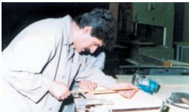
شکل ۲۹- سرهم کردن جعبه و گونیایی کردن آن
