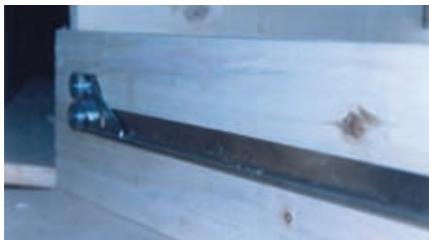
شکل ۳۰- نصب ریل روی جعبه
