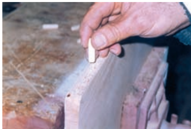
شکل ۲۵ - جازدن دوبل‌ها در نر صفحات
