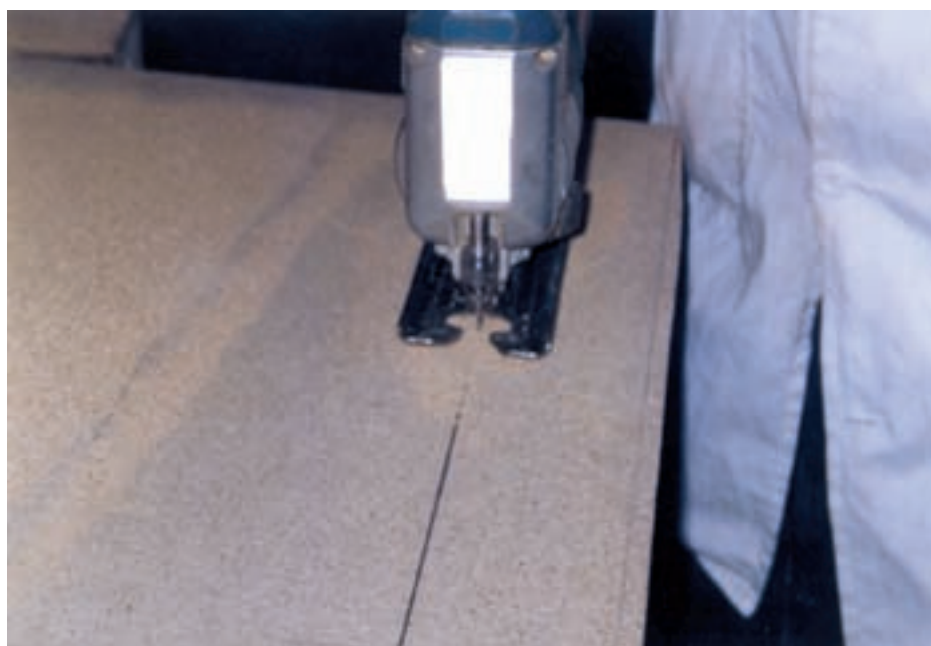
شکل ۲- بریدن نئوپان با اره‌ی عمودبر
