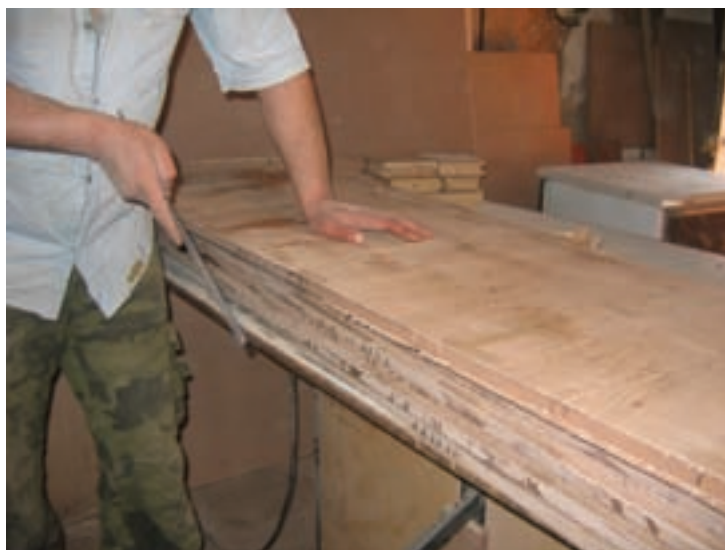
شکل ۲۲ – برطرف کردن لبه های اضافی روکش
