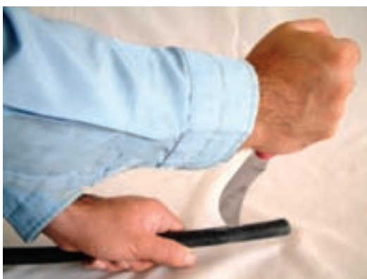
شکل ۱۶-۳ طرز صحیح روکش برداری از کابل
