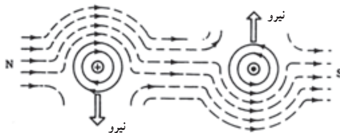
شکل ۸-۷- به هادی حامل جریان در میدان مغناطیسی نیرو وارد می‌شود.
