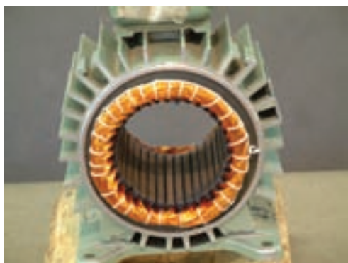
شکل ۱۱-۷- استاتور یک موتور AC
