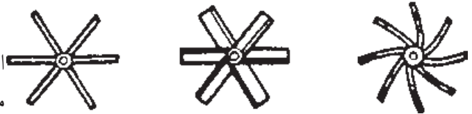
شکل ۳-۲ - انواع همزن‌های توربینی
