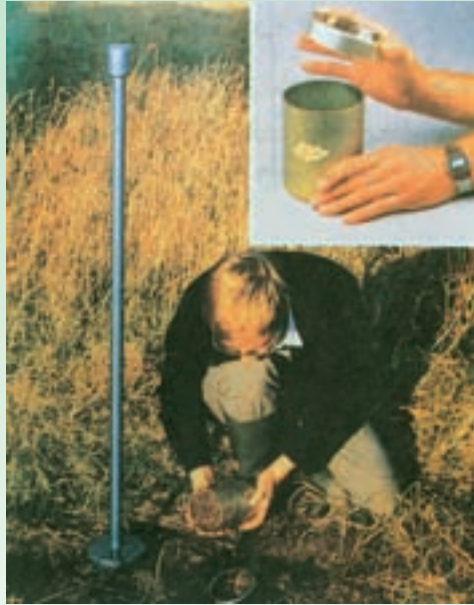
شکل ۸-۲- نمونه‌برداری از خاک با سیلندر
