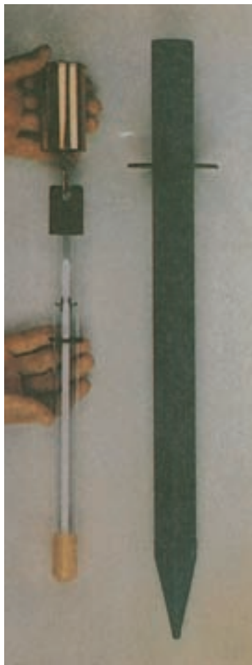
شکل ۱۰-۲- دماسنج برای اندازه‌گیری دمای عمق خاک
