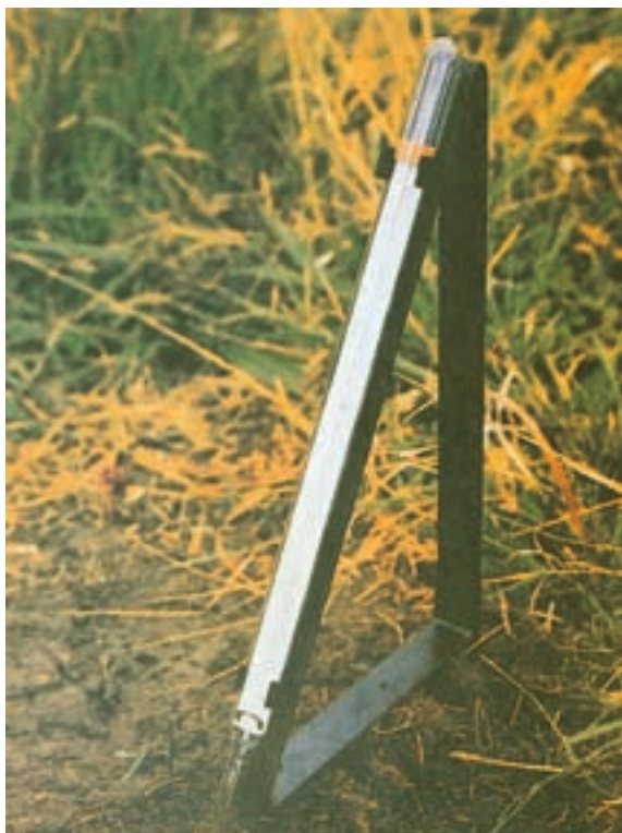
شکل ۱۱-۲- دماسنج برای اندازه‌گیری دمای سطح خاک
