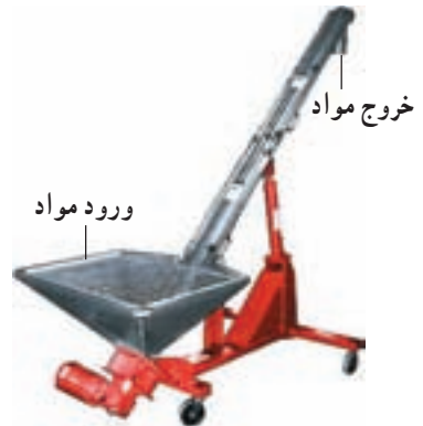
شکل ۲۱-۱- نقاله ماریچی شیبدار با قابلیت جابه‌جایی و تنظیم شیب
