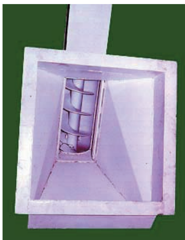
شکل ۱۵-۱- دریچه ورودی نقاله
