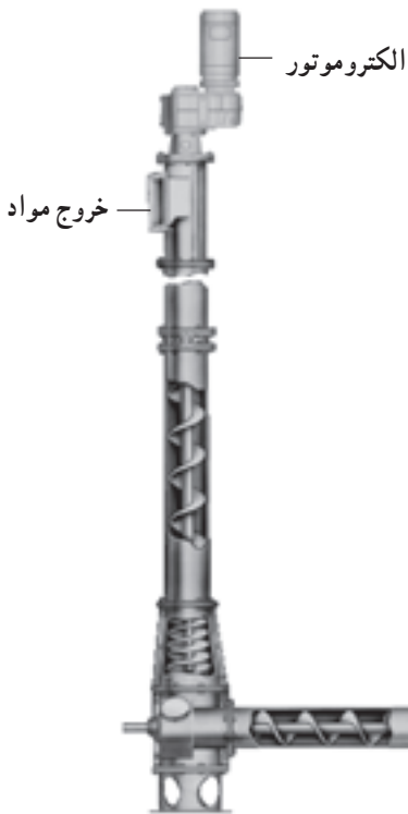
شکل ۲۰-۱- نقاله ماریچی مخصوص مسیرهای شیبدار
