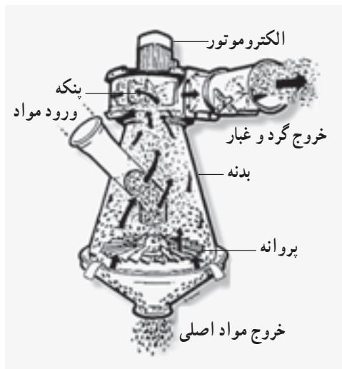
شکل ۲-۷- طرح کلی تمیزکننده گردبادی
