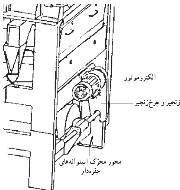
شکل ۱۹-۲- محل قرارگیری الکتروموتور استوانه‌حفره‌دار
