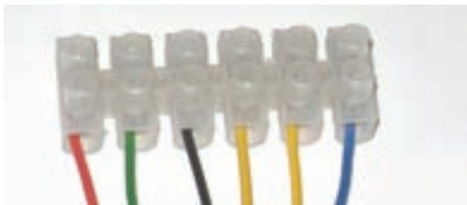
شکل ۲۴-۳ قرار گرفتن سیم‌ها زیر پیچ‌های ترمینال
