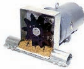
شکل ۳-۵۶- الکتروموتور و چرخنده محرک دان خوری ماریجی
