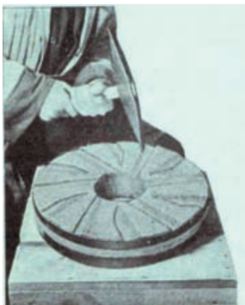
شکل ۳۹-۳- ایجاد شیار روی سنگ آسیا
