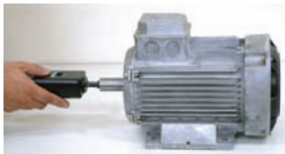
شکل ۲۷-۴ نحوه‌ی اندازه‌گیری سرعت دورانی موتور
