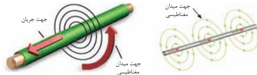
شکل ۴-۴ خاصیت مغناطیسی اطراف سیم حامل جریان
