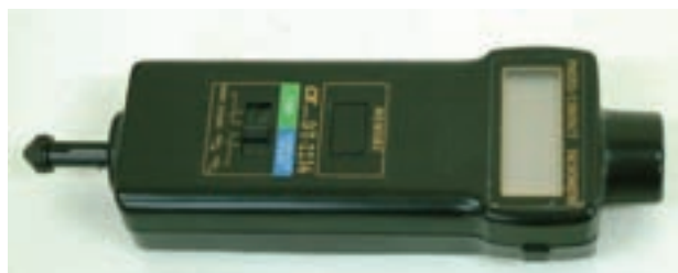
شکل ۲۶-۴ دورسنج دیجیتالی با حس‌کننده‌ی نوری و مکانیکی
