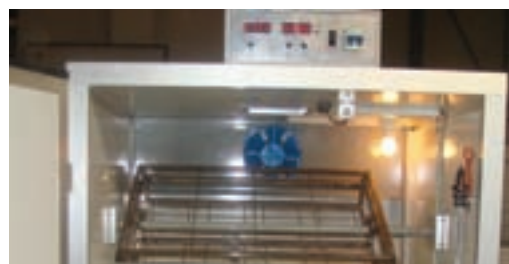
الف) هواکش دستگاه جوجه‌کشی
