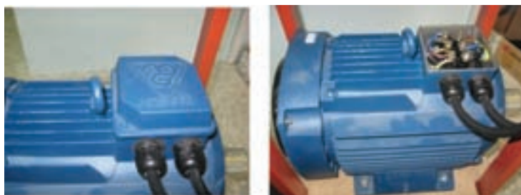
شکل ۵-۱ پلاک اتصالات موتور الکتریکی سه فاز
