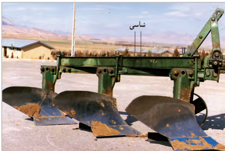
شکل ۱-۱۸— شاسی در گاواهن دار سه خیشه سوارشونده
