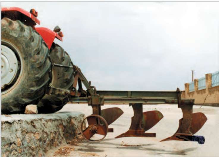
شکل ۲۶-۱- نحوه تنظیم عمق کار گاوآهن
