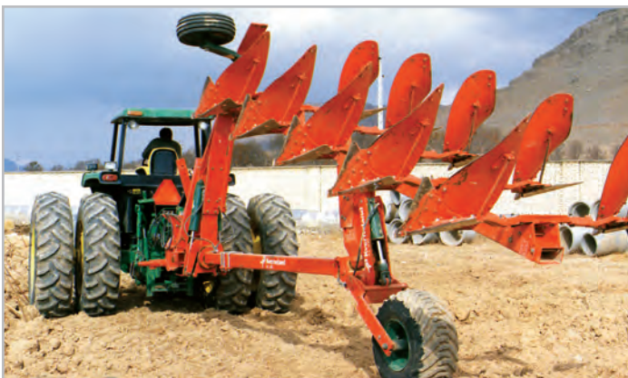
شکل ۱-۱- گاواهن دوطرفه در وضعیت حمل
