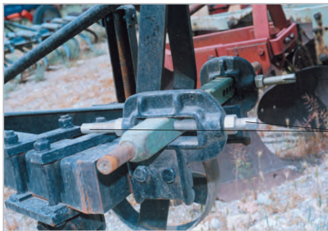
ب - محور با پیچ تنظیم جلوی گاو آهن
