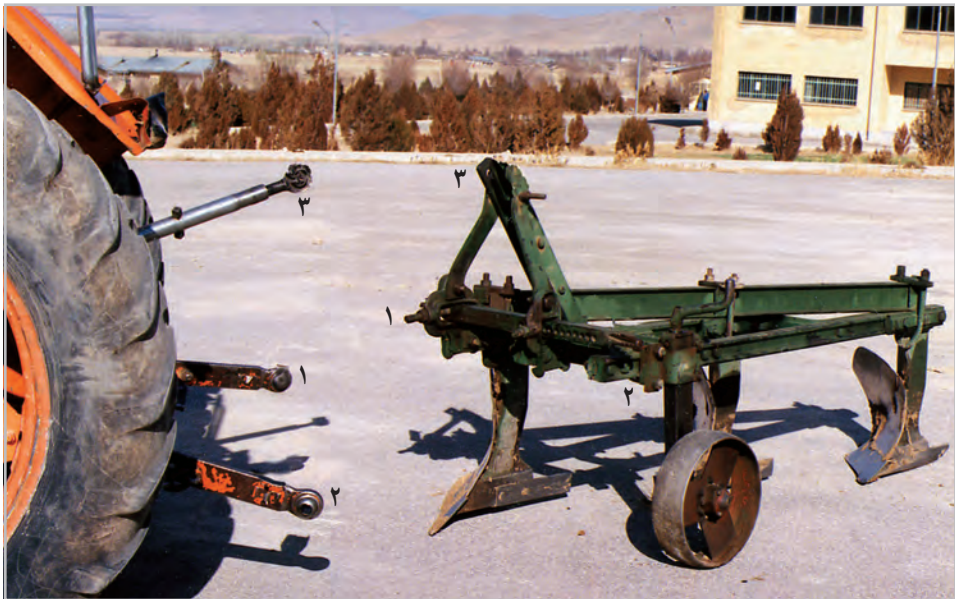
شکل ۲۰-۱- نقاط سه گانه اتصال گاوآهن و تراکتور
