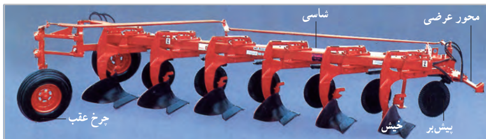
شکل ۱-۳- گاو آهن نیمه‌سوار شش خیشه
