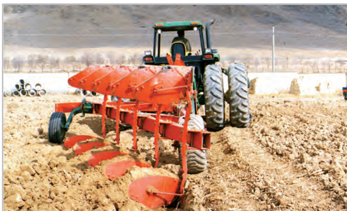
شکل ۱-۲- گاو آهن دو طرفه در حالت کار
