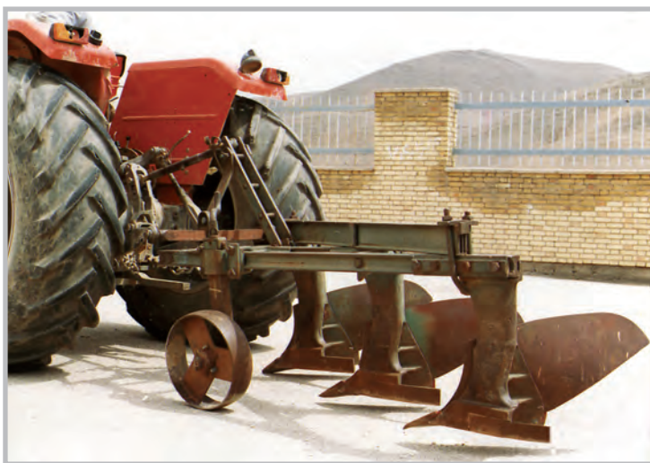
شکل ۲۷-۱- اندازه فاصله انتهایی کفش آخرین خیش با زمین
