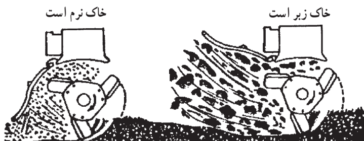
شکل ۵۷-۱- موقعیت ضمیمه محافظ متناسب با سرعت تراکتور و دور محور گردنده گاوآهن دوار
