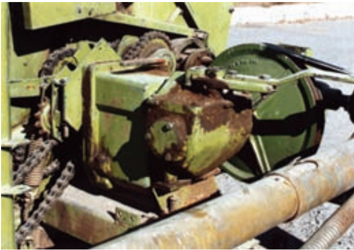
شکل ۸-۷- جعبه دنده‌ها و اجزای انتقال قدرت
