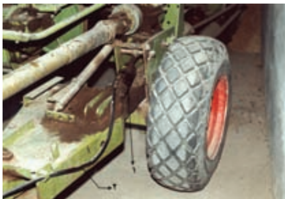
شکل ۱۱-۷- جک هیدرولیکی و شیلنگ مربوط در ذرت خردکن علفه ای
