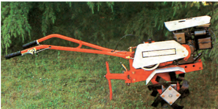
شکل ۷-۴- گاو آهن دوار مخصوص تیلر
