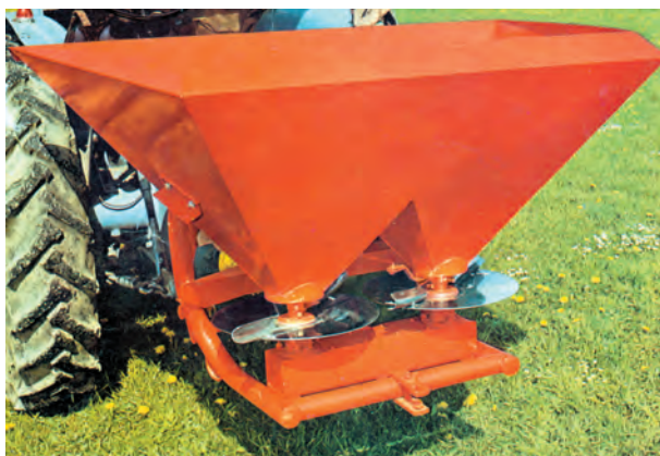
شکل ۲-۵- بذرپاش تراکتوری سوار
