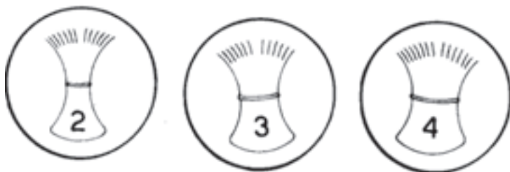
شکل ۸-۱۲ — سوراخ‌های تنظیم قطر دسته‌ها در درو دسته‌بند و دسته‌های با قطر مختلف
