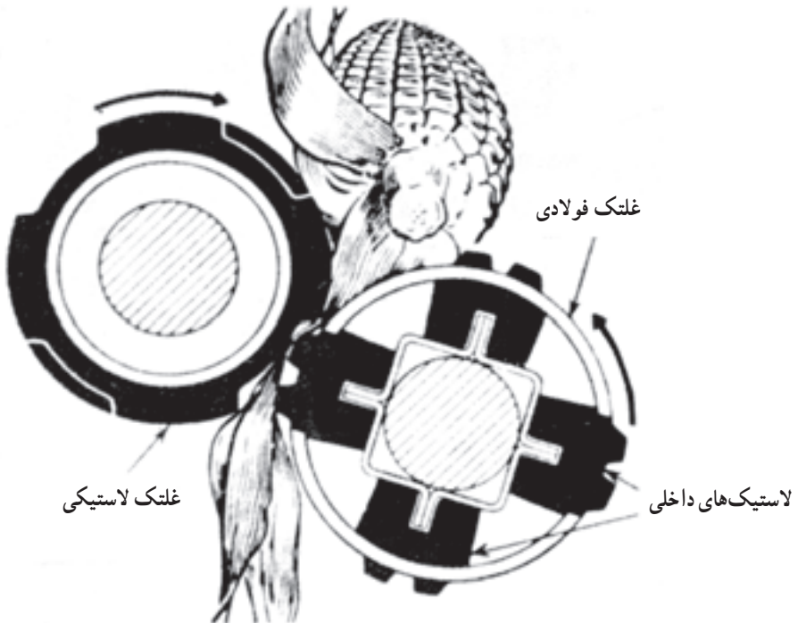
شکل ۳۳-۸- یک زوج غلتک پوست کن بلال و نحوه پوست کنی
