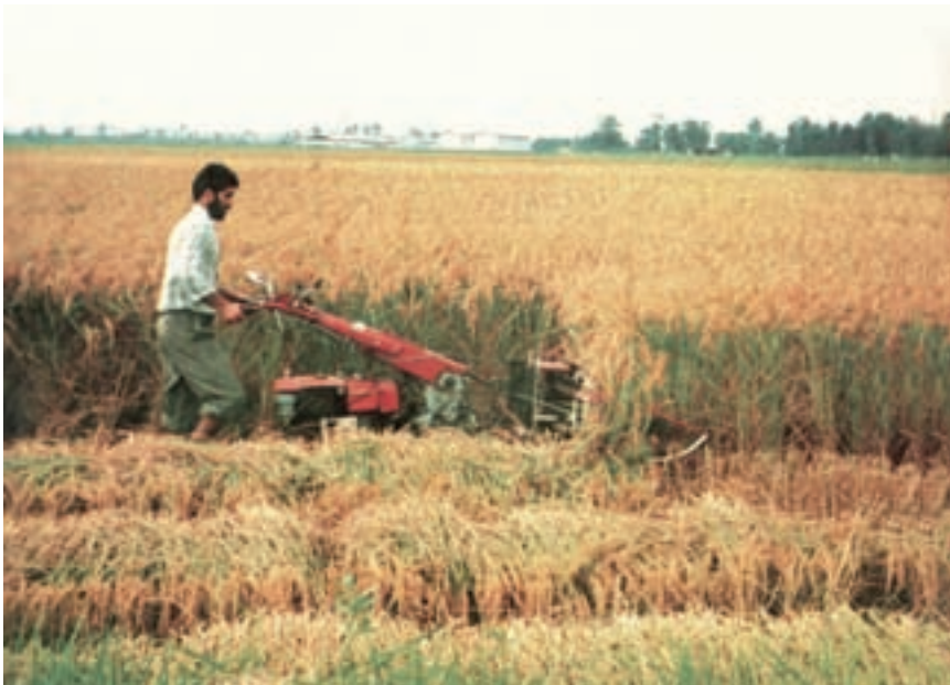
شکل ۲-۸ — دستگاه درو ردیف‌کن در حال برداشت برنج
