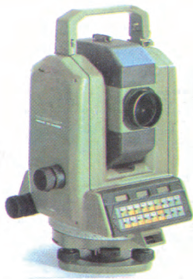
شکل ۴-۲۴- فاصله‌یاب در داخل دوربین نقشه‌برداری
