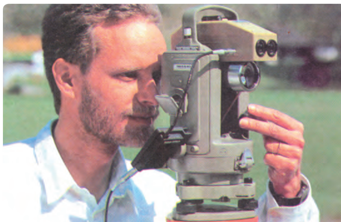
شکل ۴-۲۳- نصب فاصله‌یاب روی دوربین
