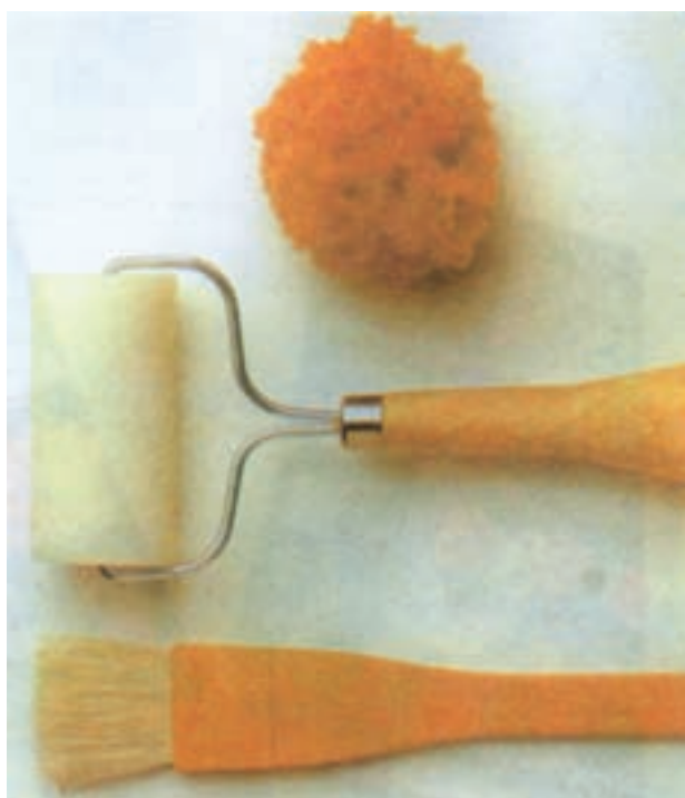
تصویر ۷۸- در تصویر نمونه‌ای از غلطک، اسفنج و قلم‌مو برای خیس کردن زمینه مشاهده می‌شود.
