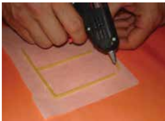
شکل ۴-۲- نحوه ساخت قاب ساختمانی با ماکارونی با استفاده از
