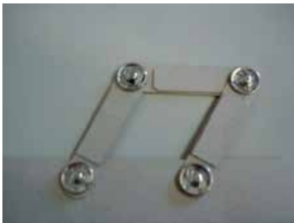
شکل ۵-۱- جابجایی قاب ساختمانی ساده مهاربندی نشده
