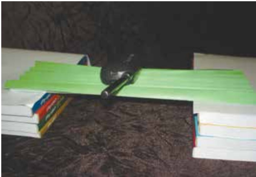
شکل ۵-۴- مقاومت خمشی پل در مقابل یک وزنه
