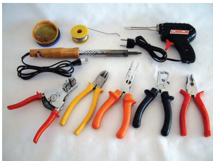
شکل ۹۱-۲- برخی ابزار کارگاه الکترونیک
