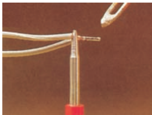
شکل ۱-۱۷ لحیم کاری سیم‌های با اتصال سر به سر
