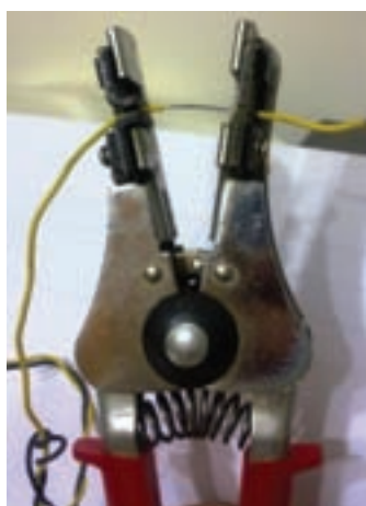
شکل (۱-۴) برداشتن روکش سیم‌ها
