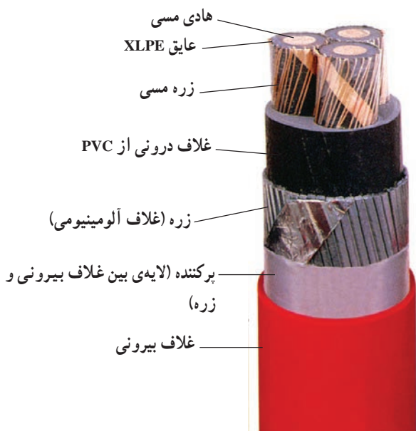
شکل ۵-۷- کابل با غلاف آلومینیومی
