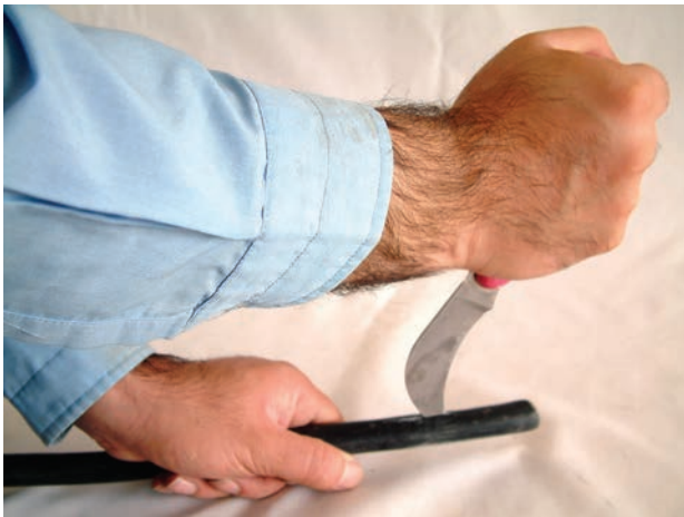
شکل ۳۳-۵- طریقه‌ی صحیح روکش برداری کابل
