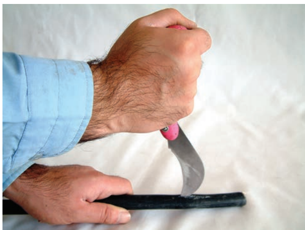
الف - نحوه ی غلط لخت کردن کابل
