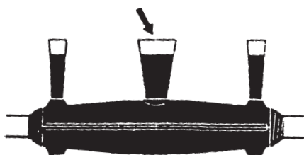
شکل ۶-۲۴- ماده‌ی رزین تا \frac{1}{4} ارتفاع قیف ریخته می‌شود.
