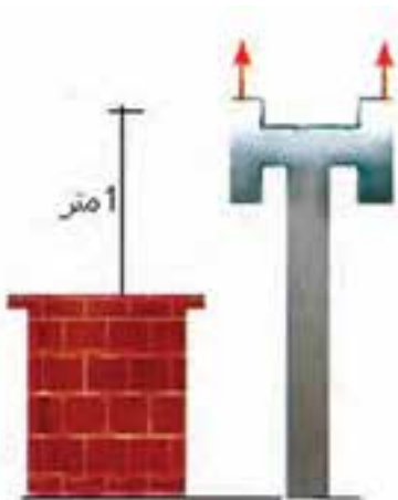
شکل ۱ - ۶۲: نصب صحیح لوله دودکش داخل اتاق
