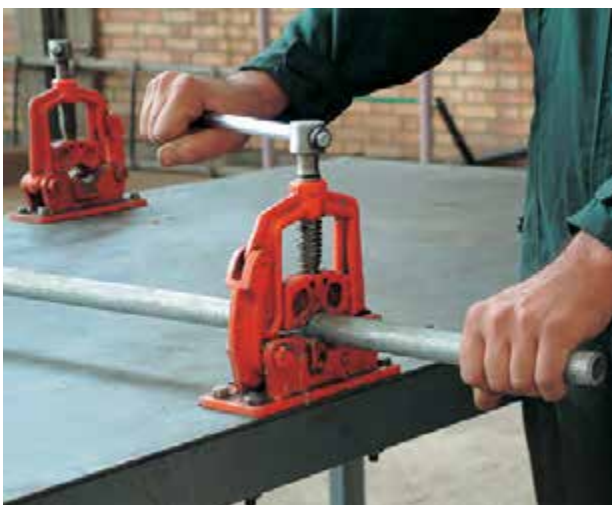
شکل ۱-۲۸- بستن لوله به گیره‌ی لوله
