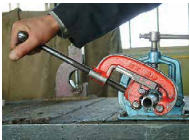
شکل ۲۰-۱- بریدن لوله‌ی فولادی به وسیله‌ی لوله بر یک تیغه‌ی یک‌دسته
