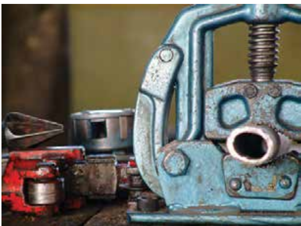
شکل ۱۶-۲- لوله‌ی دو پهن شده
