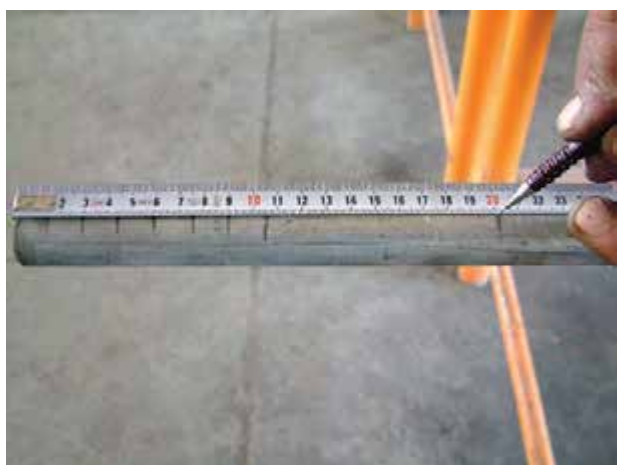
شکل ۱-۶۴-۱ خط کشی کردن لوله
