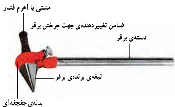
شکل ۲-۹- اجزای بر قوی جفجغه‌ای
