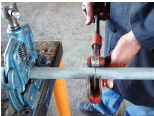
شکل ۱-۶۲- سفت کردن دسته‌ی لوله‌بر به اندازه‌ی لازم
