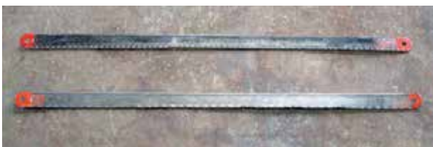
شکل ۱-۴۰ - از بین رفتن دندان‌های تیغه اژه
