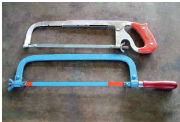
شکل ۱-۵- کمان ارّه‌ی ثابت با دسته‌ی معمولی و متغیر با دسته‌ی هفت تیری
