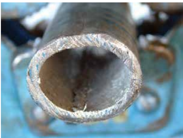
شکل ۱-۶۱- لوله‌ی دو پهن شده
