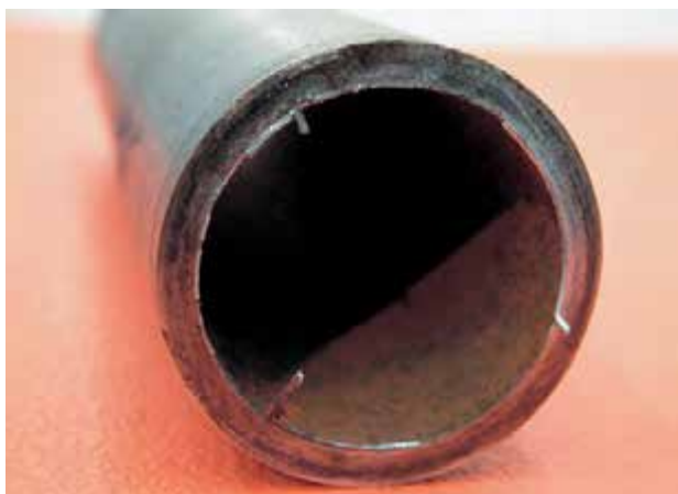
الف - لوله‌ی بریده شده به وسیله‌ی لوله‌بر
