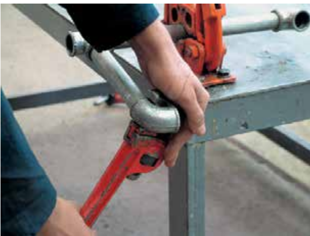
شکل ۱۰۵-۵- روش غلط سفت کردن مدار
