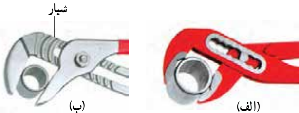
شکل ۷۰-۵- سوراخ ها و شیارهای متعدد آچارهای کلاغی
