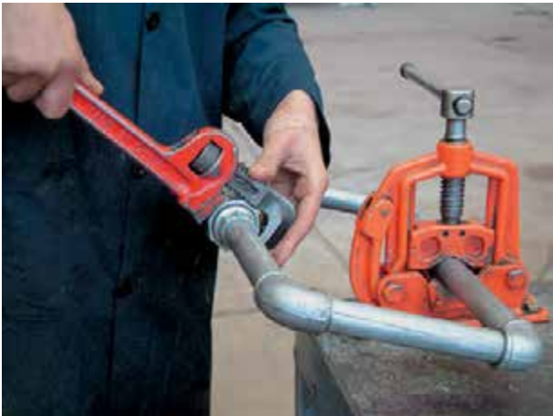
شکل ۵-۱۰۶- نحوه‌ی غلط سفت کردن مهره ماسوره
