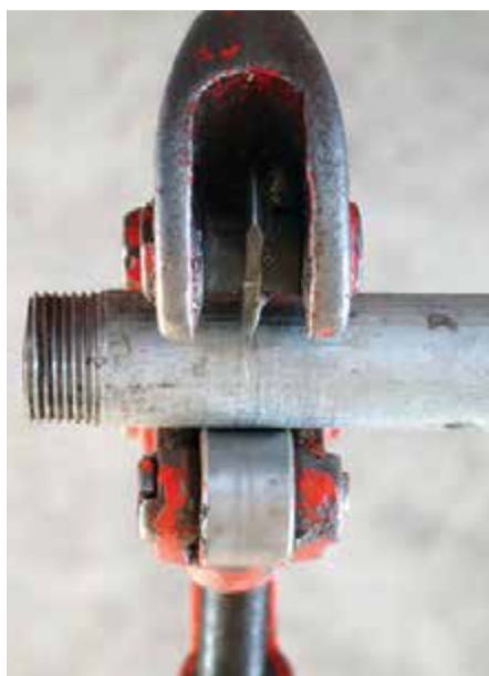
شکل ۹۶-۵- استفاده‌ی غلط از لوله‌بُر با تیغه‌ی شکسته
