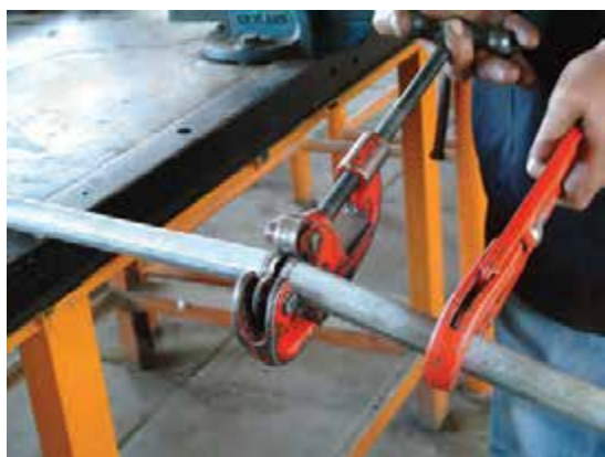
شکل ۱۱۷-۵- بریده شدن لوله و خاتمه‌ی کار
