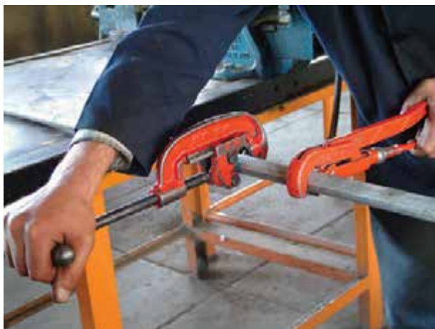
شکل ۱۱۶-۵- ادامه‌ی برش‌کاری لوله
