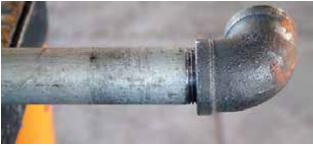
شکل ۵-۹۹- سفت کردن مناسب فیتینگ به لوله
