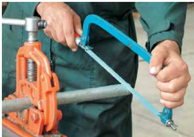
شکل ۱۲۹-۵- بریدن لوله‌های مورد نیاز به وسیله‌ی کمان اره
