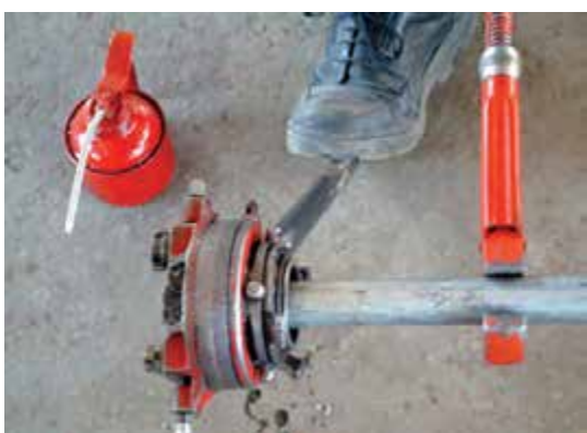
شکل ۱۲۳-۵- عمل باز کردن سردنده از پارچه‌های حدیده
