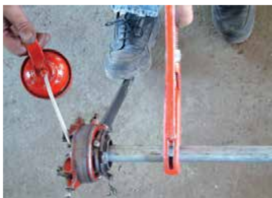
شکل ۱۲۱-۵- استفاده از روغن در جریان حدیده کاری
