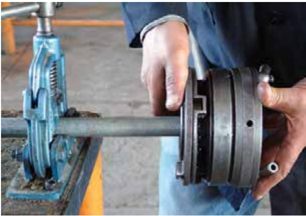
شکل ۵-۱۳۰- حدیده کردن لوله‌ها
