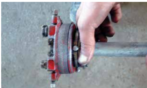
شکل ۱۲۴-۵- باز کردن فلکهای چهار نظام حدیده
