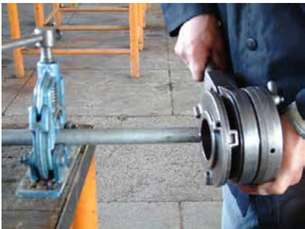
شکل ۱۳۶-۵- حدیده کردن لوله‌ها
