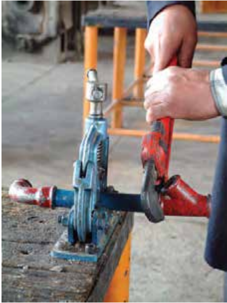
شکل ۱۳۹-۵- بستن فیتینگ‌ها به لوله‌های جدید شده
