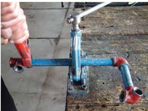
شکل ۵-۱۵۵- بستن سه‌راهی به ضلع دوم مدار
