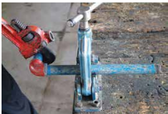
شکل ۱۵۴-۵- بستن لوله‌ی ضلع دوم مدار
