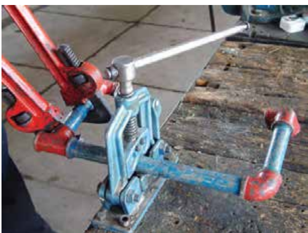
شکل ۵-۱۵۶- بستن ضلع سوم مدار به سه‌راهی
