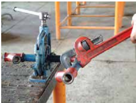
شکل ۱۴۰-۵- بستن ضلع دوم مدار مثلث شکل
