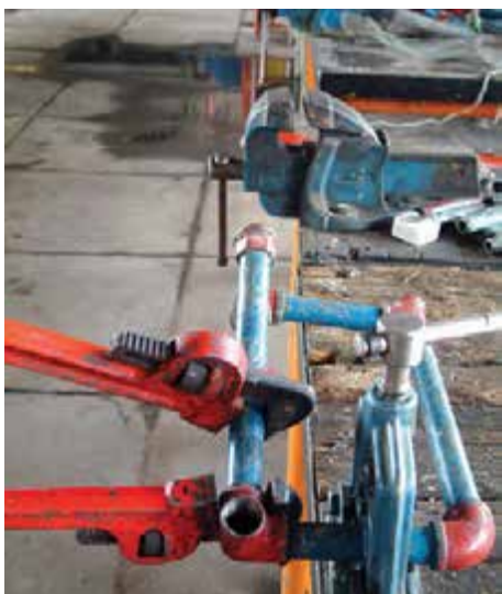
شکل ۱۵۸-۵- بستن قسمت بعدی مهره ماسوره به سه‌راهی کنج
