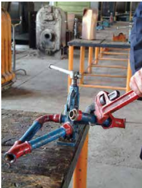
شکل ۱۴۱-۵- بستن یکی از قطعات به سهراهی
