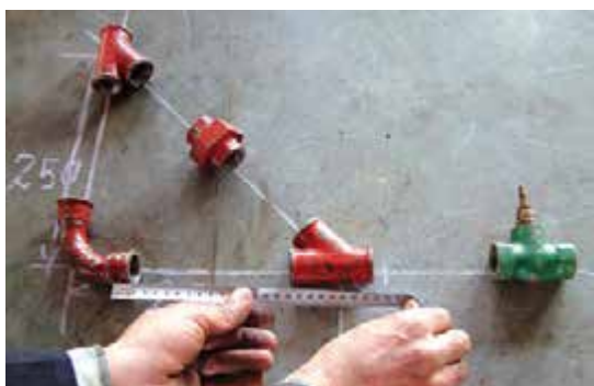
شکل ۱۳۴-۵- اندازه‌گیری لوله‌های مورد نیاز
