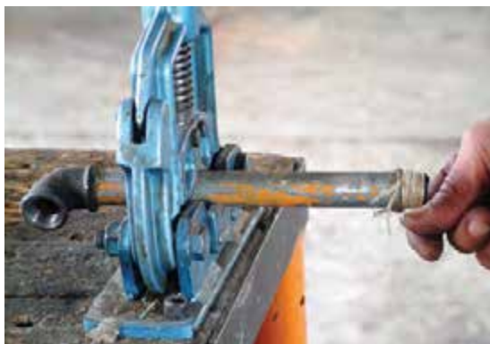
شکل ۱۵۳-۵- خمیر و کنف کردن سردنده‌ی بعدی
