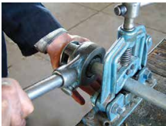
شکل ۱۵۱-۵- حدیده کردن لوله‌ها
