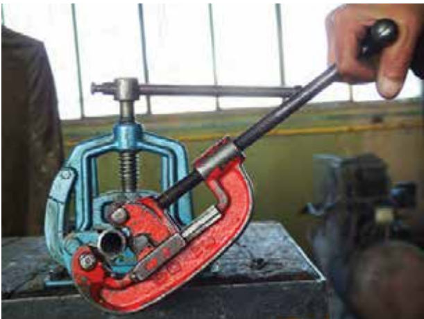
شکل ۱۵۰-۵- بریدن لوله ها
