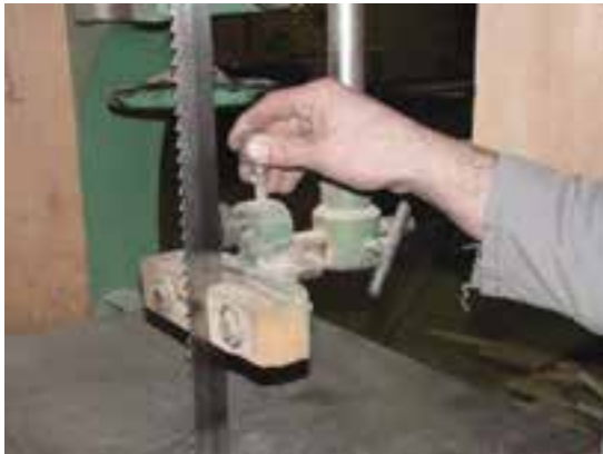
شکل ۵۲-۱- نمونه‌ی تنظیم فاصله‌ی بلبرینگ با پشت تیغه.
