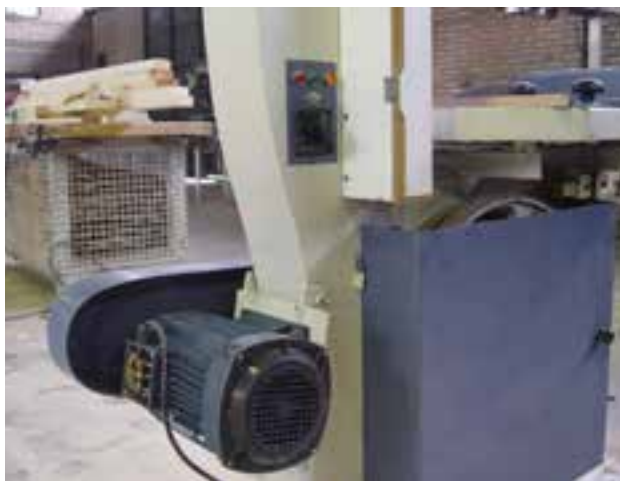
شکل ۲۷-۱- الکتروموتور تک فاز با فازن راه انداز.
