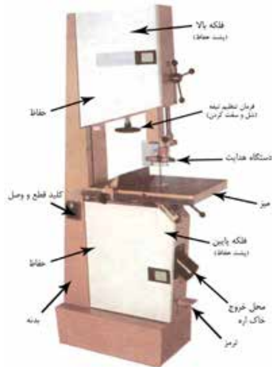
شکل ۴۱-۱. قسمت‌های مختلف یک ماشین اره‌نواری.
