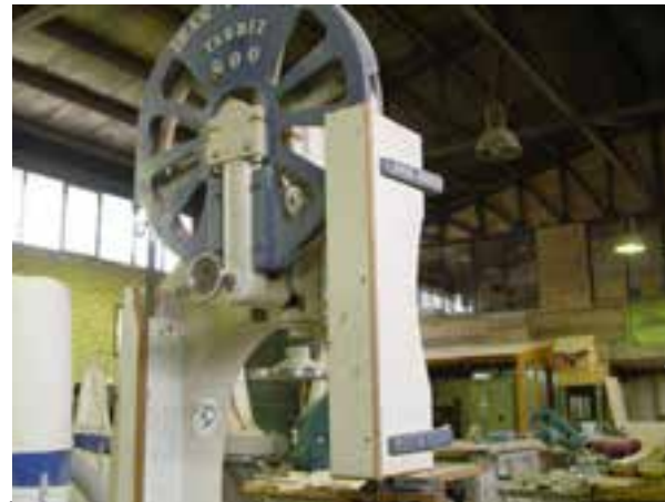
شکل ۱۰-۱- حفاظ‌های روی تیغه مد فاصل بین دو فلکه
