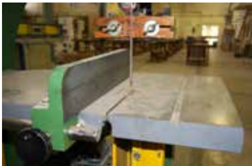
شکل ۱۲-۱- گونیا ثابت یا طولی.
