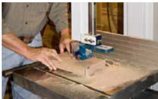
شکل ۳۵- ۱- فاصله‌ی ارتفاع سطح چوب با دستگاه هدایت.
