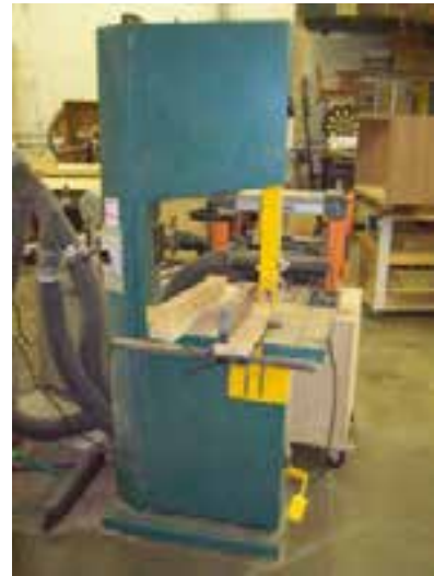
شکل ۹-۱- یک ماشین اره‌نواری، با حفاظ کامل.
