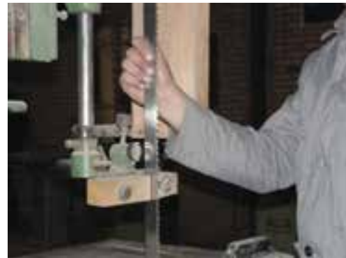
شکل ۵۱-۱- کنترل سفتی تیغه به کمک دست.
