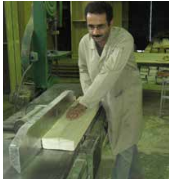
شکل ۱۶-۴- طرز ایستادن صحیح در کنار ماشین.
