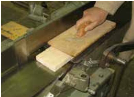
شکل ۱۷-۴-ب - رنده کردن چوب‌های کم ضخامت.
