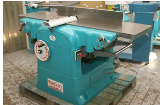
شکل ۴-۴- ماشین کفرند با بدنه چدنی.
