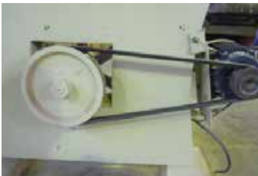
شکل ۳-۱۷. استقرار تسمه در داخل چرخ تسمه.
