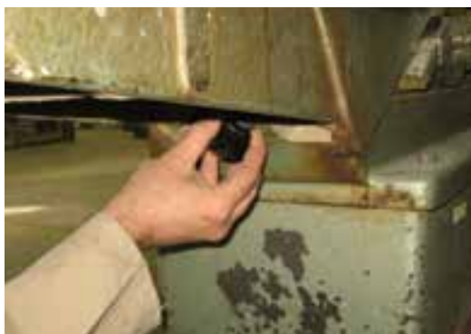
شکل ۹-۴- اهرم ثابت کننده‌ی صفحه.
