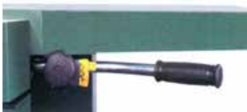
شکل ۸-۴- اهرم تنظیم بار صفحه‌ی کفرند.
