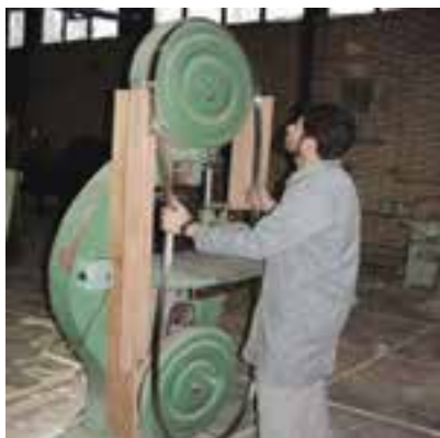
شکل ۵-۲. خارج کردن تیغه اره از روی فلکه‌ها.
