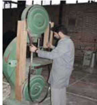
شکل ۶-۲- نمونه‌ی جا انداختن تیغه اره.
