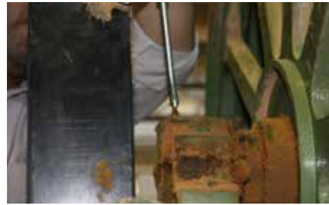
شکل ۳-۱۳. گریس کاری یاتاقان فلکه اره.
