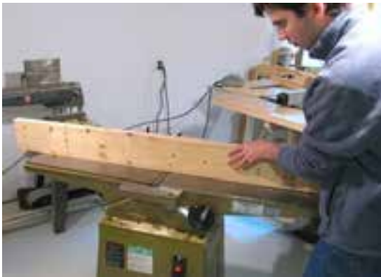
شکل ۴-۲۴ - پس از (ندیدن) (۹)، باید نرِ چوب (۱۰) نیز رنده کرد.
