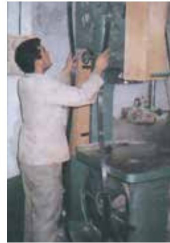
شکل ۱۰-۲- نمونه‌ی فارغ کردن تیغه اره.
