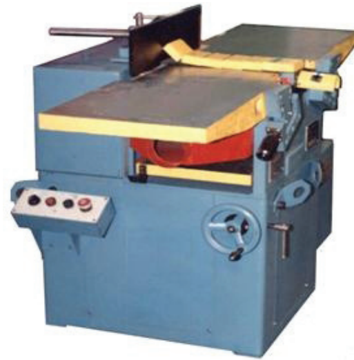
شکل ۴-۳۲- ماشین رنده با حفاظ.
