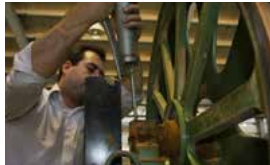
شکل ۳-۱. گریس‌کاری یاتاقان فلکه (اره).
