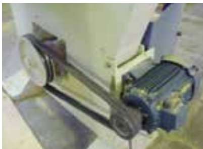
شکل ۳-۴. انتقال نیرو توسط تسمه.
