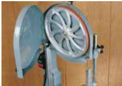
شکل ۴-۲. مفاظ باز شده‌ی روی فلکه و تیغه.
