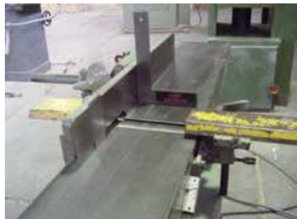
شکل ۳۰-۴. کنترل گونیا ماشین.
