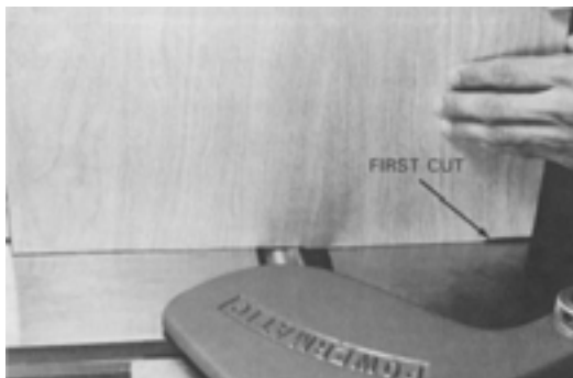
شکل ۴-۲۵ - پله شدن چوب.
