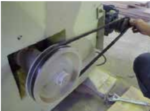
شکل ۳-۱۶. تعویض تسمه فرسوده.
