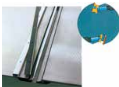
شکل ۱۵-۱۴- توپی (میله‌ی رنده) و تیغه‌ها.
