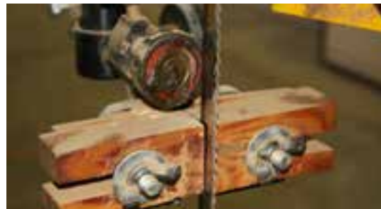
شکل ۳-۲. گریس‌کاری بلبرینگ تیغه (اره).
