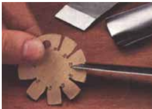
شکل ۴-۵- شابلن مخصوص کنترل زاویهی رنده.
