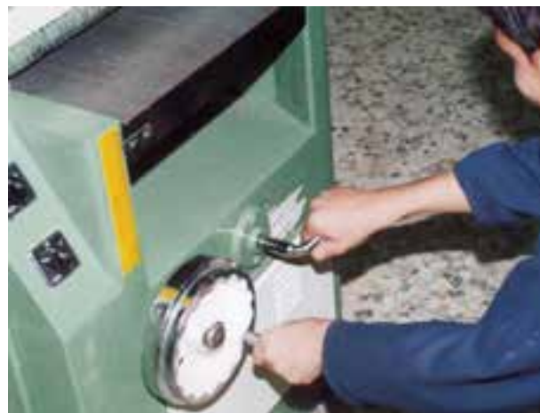
شکل ۱۹-۷- تنظیم صفحه و مسمک نمودن اهرم مربوطه.
