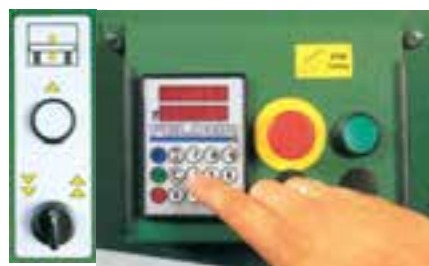
شکل ۲- ۷- کلید و راهنمای بالابر اتوماتیک و تنظیم ضخامت با
