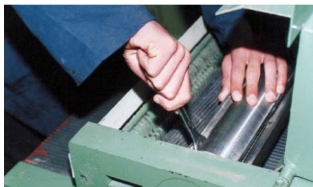
شکل ۲۴-۷- نمونه‌ی بستن تیغه‌ها به توپی.
