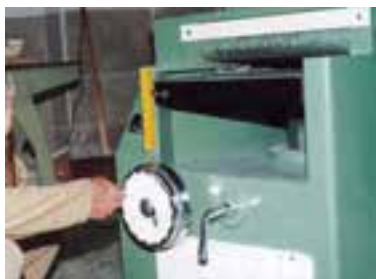
شکل ۲۱-۷- آزمایش روان بودن مرکب صفحه‌ی متمرک.
