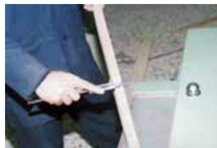
شکل ۴۸-۷- کنترل ضخامت چوب گندگی شده، با کولیس.
