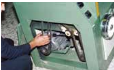
شکل ۲۶-۷- کنترل سفتی تسمه‌ی انتقال نیرو.
