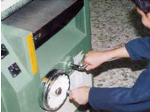
شکل ۷-۳۴ - تنظیم مقدار بار گندگی.
