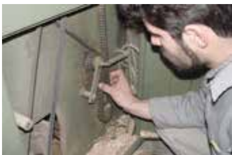
شکل ۲۷-۷- تنظیم و آزمایش سفتی زنجیر انتقال نیرو.
