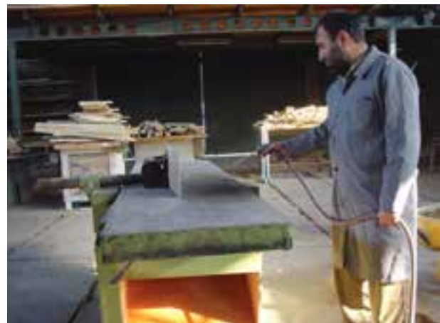
شکل ۱۲-۶- غبارگیری ماشین با شیلنگ باد.
