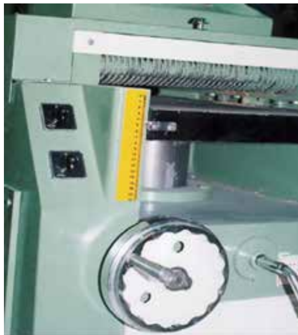
شکل ۱۶-۷- دقت کنید: ماشین برای ضخامت ۴۳ سانتی‌متر تنظیم شده است.
