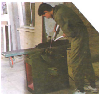
شکل ۱۵-۶- گریس‌کاری یاتاقان‌های توپی رنده.
