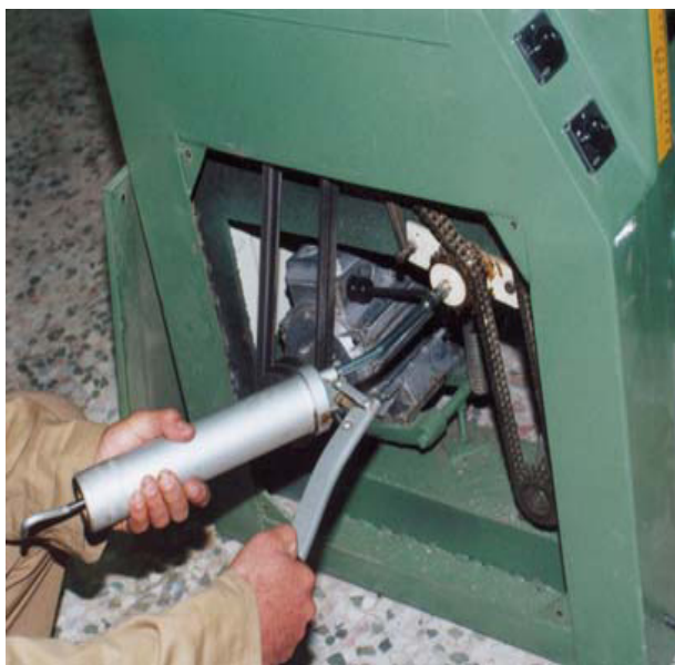
شکل ۸-۷- گریس‌کاری مموره‌های انتقال نیرو.
