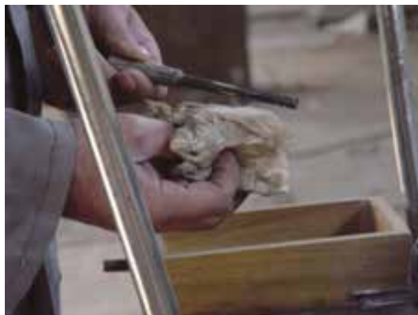
شکل ۱۶-۱۰- تمیز کردن مته‌های خارج شده از ماشین.
