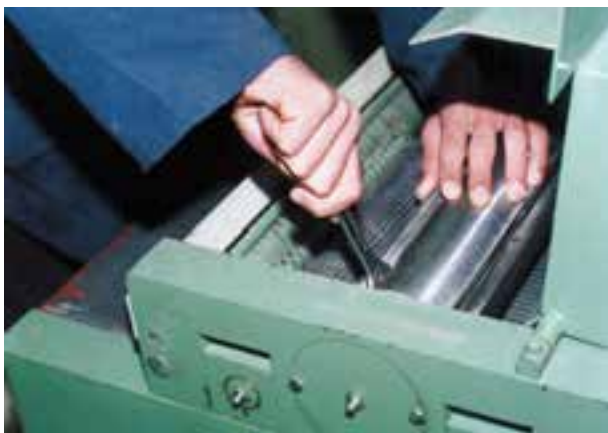
شکل ۹-۸- استفاده از آچار تفت برای باز یا بستن تیغه‌ها.
