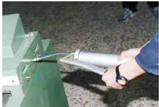
شکل ۸-۱. گریس‌کاری بلبرینگ یاتاقان‌ها.
