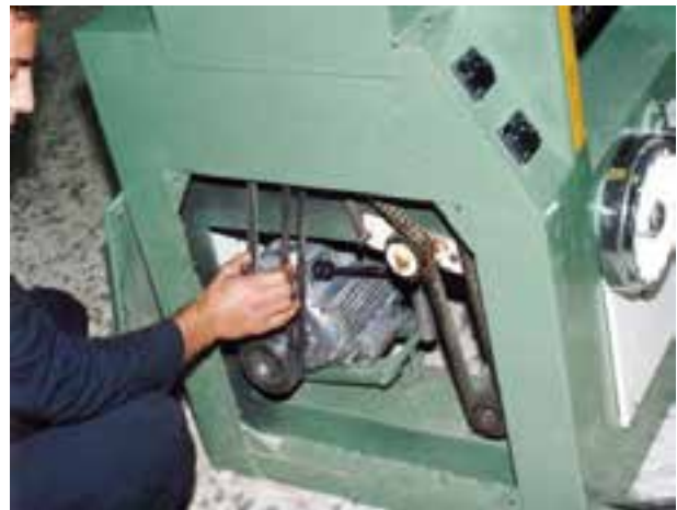
شکل ۸-۱۶- کنترل تسمه‌های انتقال نیرو
