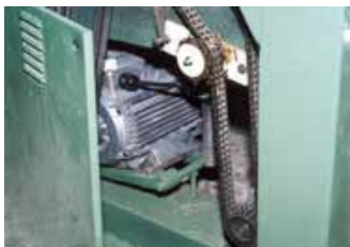
شکل ۸-۱۴- باز کردن درپوش برای روغن‌کاری.
