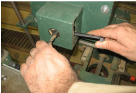
شکل ۹-۱۷- مهم‌ کردن مته داخل سه‌نظام.
