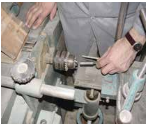
شکل ۱۰-۷- خارج کردن مته از سه‌نظام.
