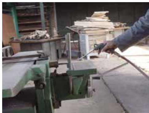
شکل ۱۰-۱۹ - غبارگیری ماشین کُمن کنی.
