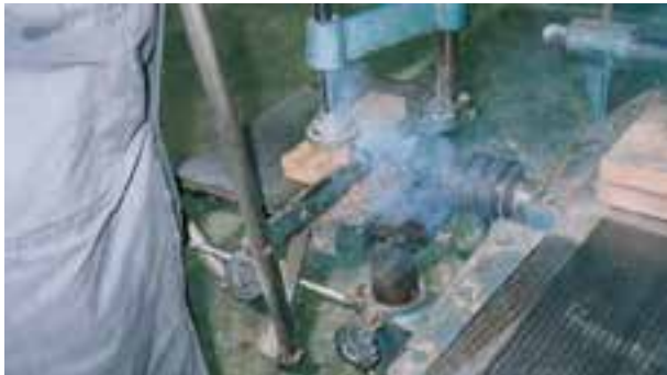
شکل ۹-۲۴ - سوهفتن چوب به هنگام کُم کنی.
