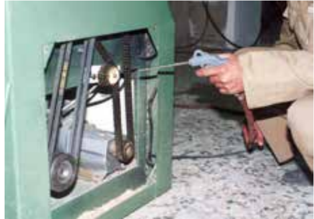
شکل ۸-۱۵- بادگیری داخل قسمت انتقال نیرو.
