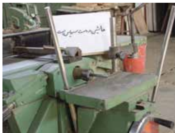
شکل ۱۰-۸- تابلوی هشدار سرویس‌کاری.
