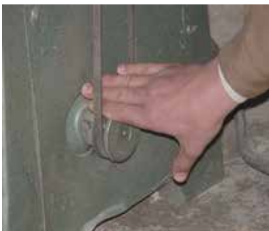
شکل ۱۰-۶- مراقبت از انگشتان به هنگام تعویض تسمه.
