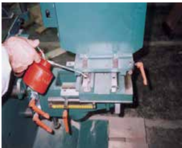
شکل ۱۳-۱- روغن‌کاری ممل ریل‌ها.
