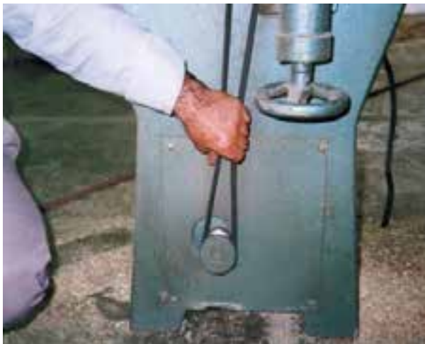
شکل ۱۰-۱۰- کنترل تسمه‌ی ماشین.
