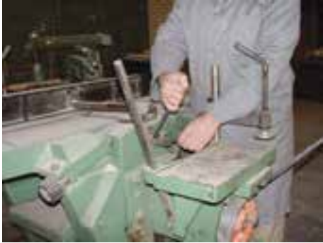
شکل ۹-۱۲ - قراردادن مته در سه نظام.
