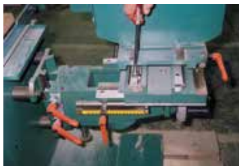
شکل ۱۰-۲۱ - سفت کردن پیچ‌های شُل شده.
