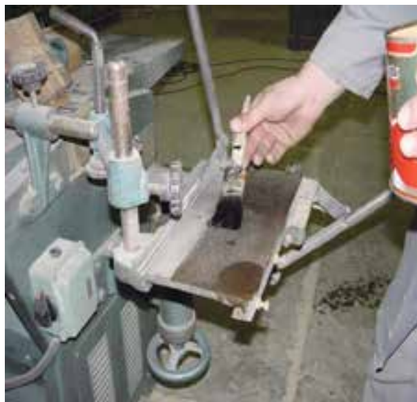
شکل ۱۲-۱- چرب کردن صفحات با روغن.
