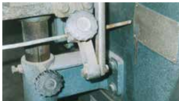
شکل ۹-۸ - سیستم تنظیم عمق کُم.
