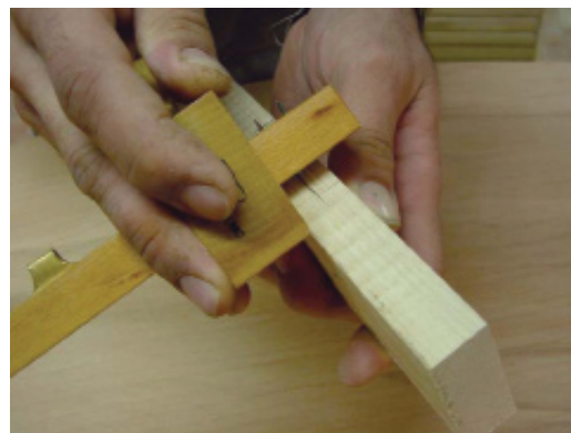
شکل ۹-۱۵- تعیین وسط نر چوب به‌وسیله‌ی فطکش تیره‌دار.
