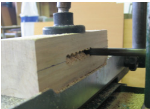
شکل ۹.۳۸ - برداشتن فاصله‌ی دو سوراخ.
