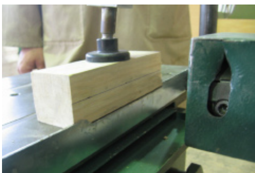
شکل ۹-۱۶- نمونه‌ی قرار دادن چوب (روی صفحه).
