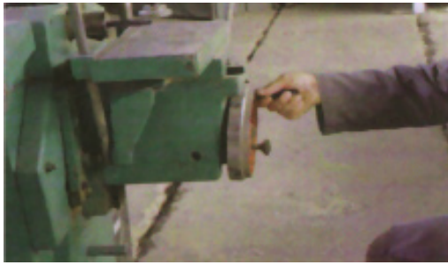
شکل ۱۰-۳- میله و سیستم تنظیم ارتفاع صفحه‌ی متمرک.
