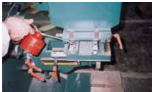
شکل ۱۰-۲۰ - روغن کاری ریل‌ها.
