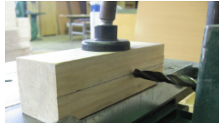
شکل ۹-۱۸- تنظیم نیش مته با قط وسط چوب.
