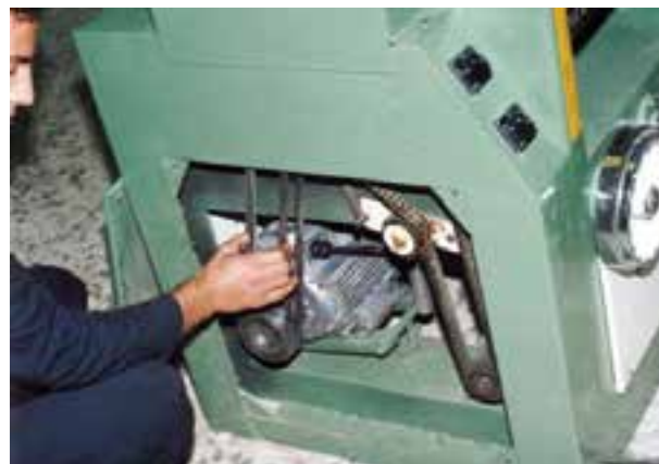
شکل ۸-۸- کنترل مقدار کشش تسمه‌ها.
