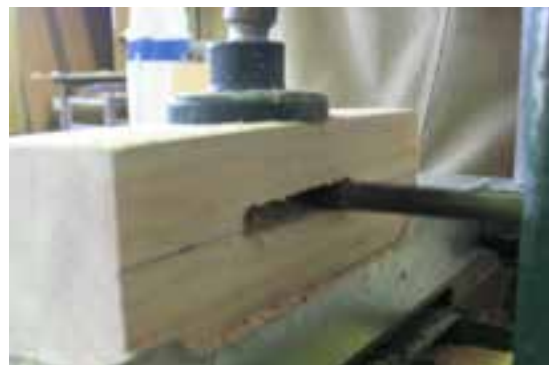
شکل ۱۰-۲- گیره‌ی نگه‌دارنده‌ی قطعه کار.
