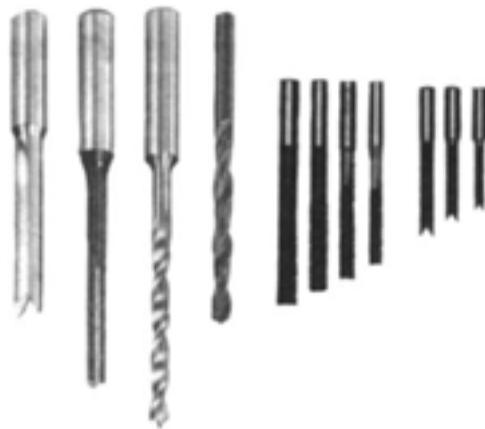
شکل ۹-۱۱ - انواع مته‌های مخصوص کُم کنی.
