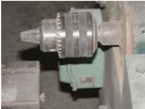
شکل ۹-۵ - سه‌نظام در ماشین گُم‌کنی.
