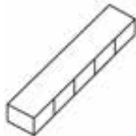
شکل ۹-۳۰- تقسیم نر چوب به ۵ قسمت مساوی.
