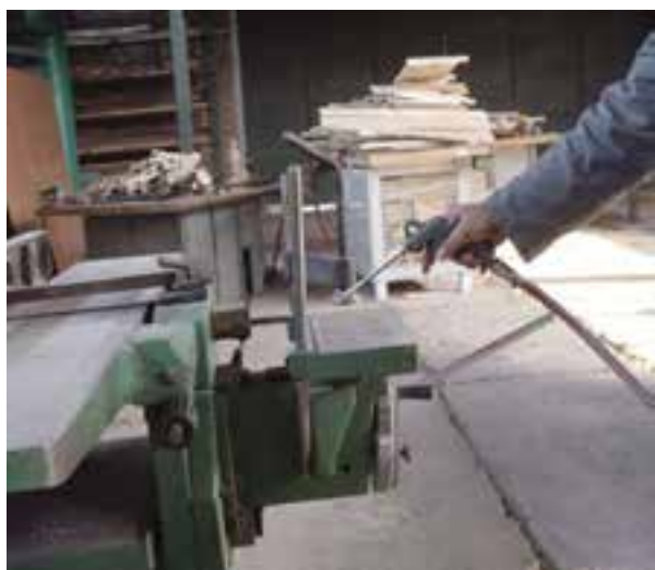
شکل ۱۰-۱۱- غبارگیری قطعات ماشین.
