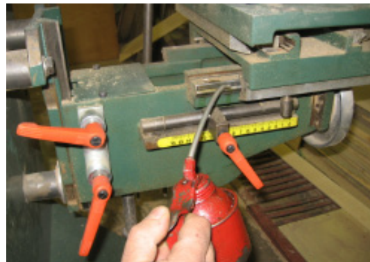
شکل ۱۰-۱- روغن‌کاری (ریل‌ها و کشوهای صفحه‌ی متمرک).
