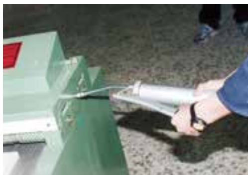
شکل ۸-۱۳- گریس‌کاری یاتاقان‌های ماشین.
