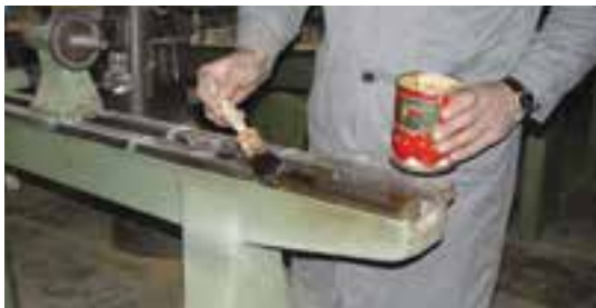
شکل ۱۱-۴۵- تمیزکاری قسمت‌های ضروری و بدون رنگ ماشین.
