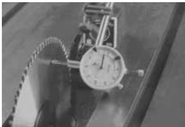
شکل ۱۲-۲۴- کنترل لنگی تیغه با دستگاه لنگی‌سنج.
