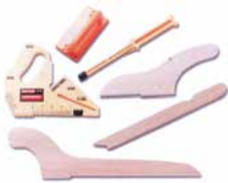
شکل ۱۲-۳۶- ابزارهای کمکی و مفاظتی.
