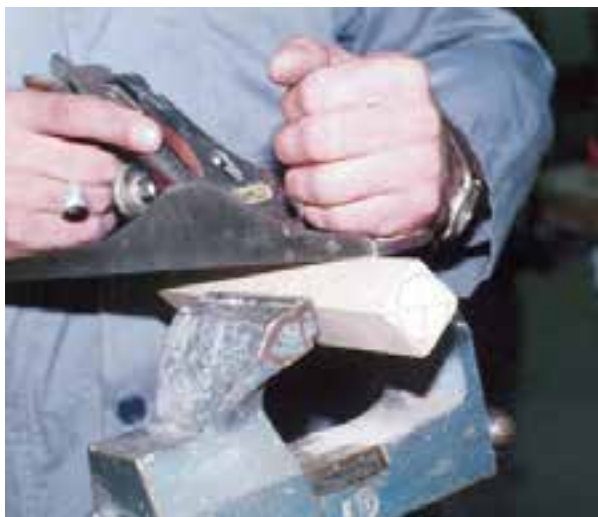
شکل ۱۱-۲۴- پیغ (زدن گوشه‌های تیز چوب).
