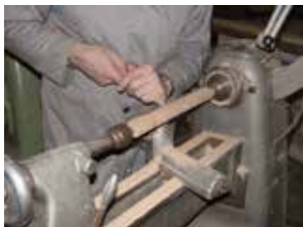
شکل ۱۱-۶۱- گرد کردن کامل قطعه چوب هشت ضلعی.
