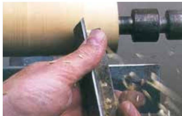
شکل ۱۱-۵۰- گرد کردن نهایی چوب با مغار گلوبی.
