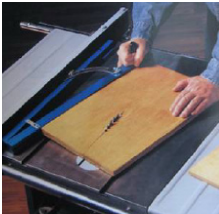
شکل ۱۲-۲۹- برش مورب با ابزار کمکی.
