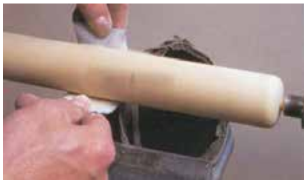
شکل ۱۱-۳۵- به وسیله‌ی سناده‌ی زبر، چوب فرامی‌گردد.
