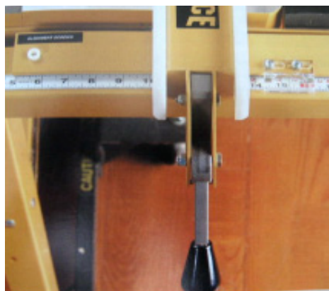
شکل ۱۲-۲۳- تنظیم اندازه‌ی برش.
