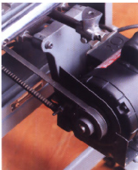
شکل ۱۲-۳۳- تسمه‌ی انتقال نیرو و حرکت.
