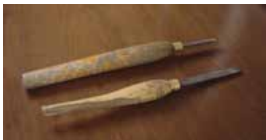
شکل ۱۱-۲۰- نمونه‌ای از مغارهای با دسته‌ی معیوب.
