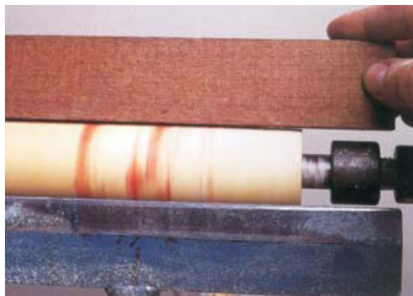
شکل ۱۱-۵۱- کنترل صافی قطعه چوب گرد شده.
