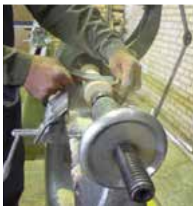
شکل ۱۱-۲۱- نمونه‌ی سنباده‌کاری قطعه چوب فراطی شده.
