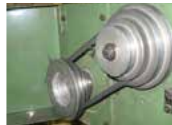
شکل ۱۱-۶- پولی تبدیل دور.
