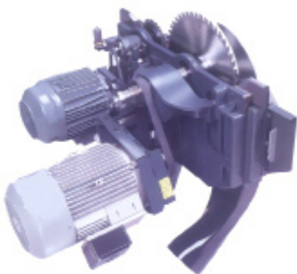
شکل ۱۲-۷- الکترو موتور و سیستم انتقال نیرو.
