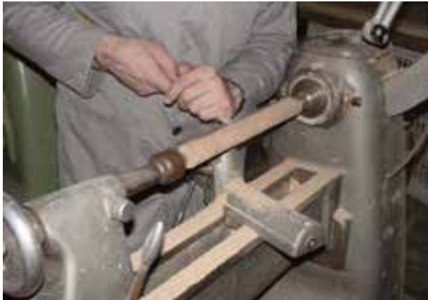
شکل ۱۱-۲۷- نمونه‌ی قرار گرفتن مغار گلوبی هنگام فراطی.
