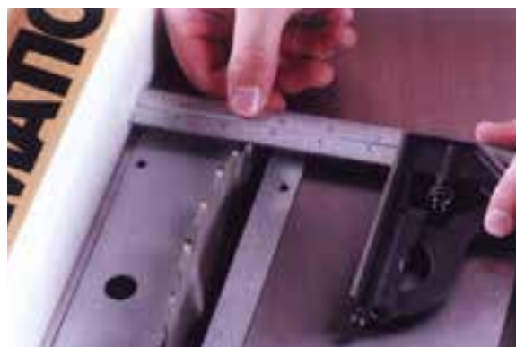
شکل ۱۲-۱۹- تنظیم فاصله‌ی تیغه تا گونیا.
