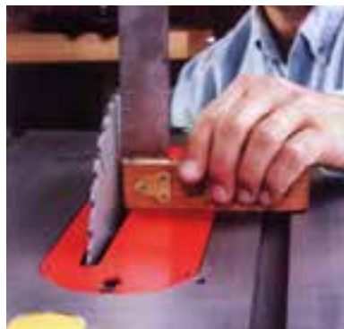
شکل ۱۲-۱۶- کنترل زاویه‌ی تیغه.
