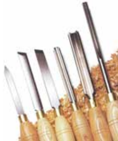
شکل ۱۱-۱۲- فرم‌های متفاوت نوک مغارها.
