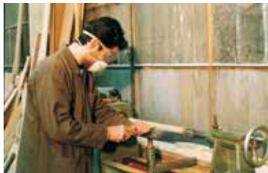
شکل ۱۱-۲۲- آستین‌های بلند لباس کار، هنگام کار، خطر آفرین است.
