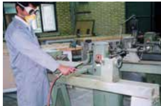
شکل ۱۱-۴۴- گردگیری و نظافت ماشین فراطی.
