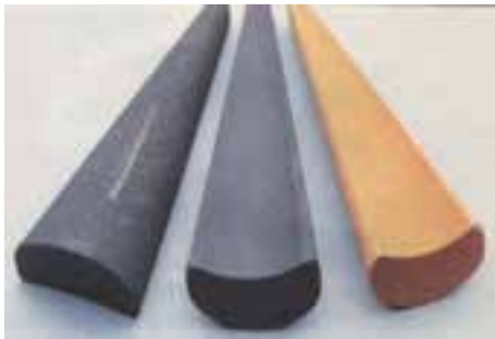
شکل ۱۱-۴۲- سنگ تیزکن مخصوص مغار گلوبی.
