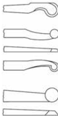
شکل ۱۱-۱۷- مغارهای مخصوص سطوح مقعر و فضاهای داخلی.
