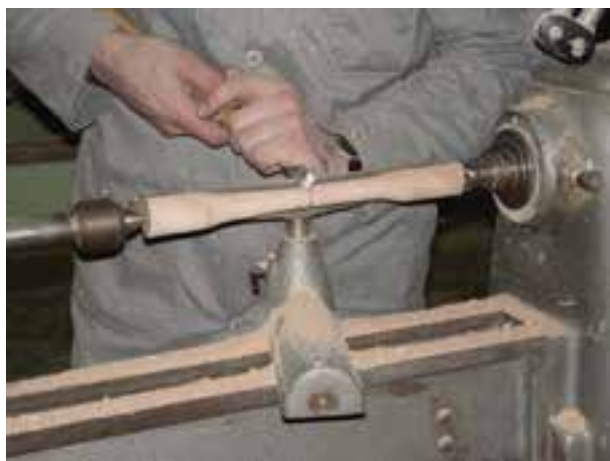
شکل ۱۱-۶۵- نمونه‌ی ایجاد شیار.
