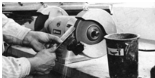
شکل ۱۱-۳۷- نمونه‌ی قرار گرفتن مغار برای تیز کردن نوک آن.
