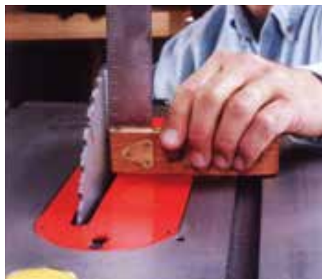
شکل ۱۲-۲۲- کنترل و تنظیم گونیایی بودن تیغه.
