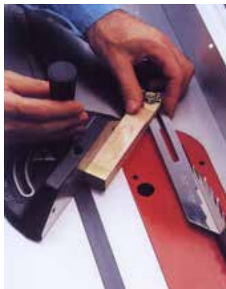
شکل ۱۲-۲۰- تنظیم زاویه‌ی تیغه
