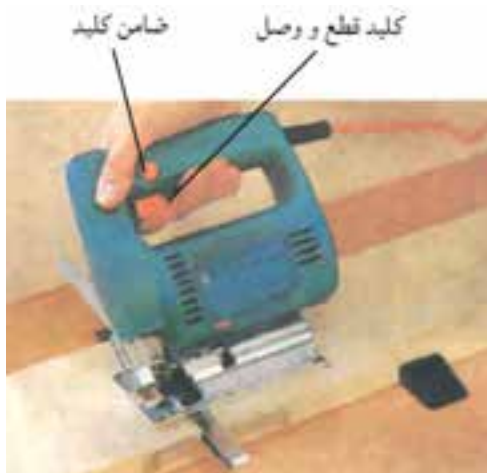
شکل ۴-۱۵- کلید قطع و وصل و ضامن کلید.
