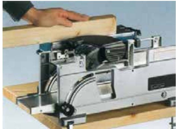
شکل ۱۴-۲۰- کاربرد میز کمکی در موقع رندیدن.
