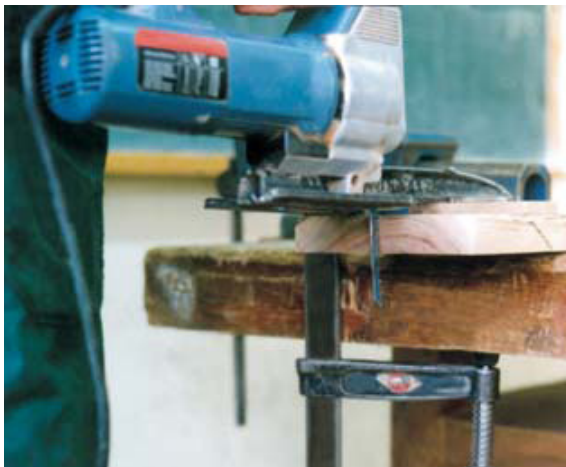
شکل ۳۵-۱۵. صفحه، کاملاً روی چوب قرار نگرفته است.
