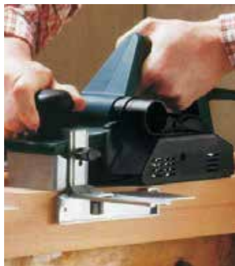
شکل ۱۴-۳۲- تنظیم گونبای سمت چپ رنده
