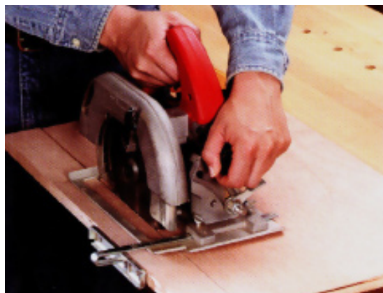
شکل ۱۳-۱۶ برش با استفاده از گونیای ماشین.
