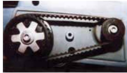
شکل ۹-۱۴- وضعیت قرار گرفتن تسمه روی پیرغندنه.
