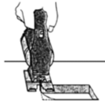
شکل ۱۵-۳۷- نمونه‌ی بریدن گوشه‌های داخلی با زاویه‌ی ۹۰ درجه.
