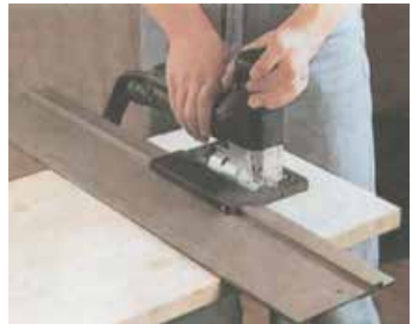
شکل ۱۵-۲۰- برش عرضی چوب به کمک ریل راهنما.
