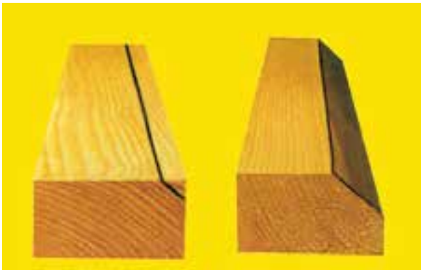
شکل ۳۰-۱۴- چوب فطاکشی شده و پیغ فورده. فط ترسیم، تا آفرین لمظه باقی می‌ماند.
