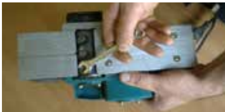
شکل ۱۴-۲۳- خارج کردن تیغه‌ها از جایگاه.
