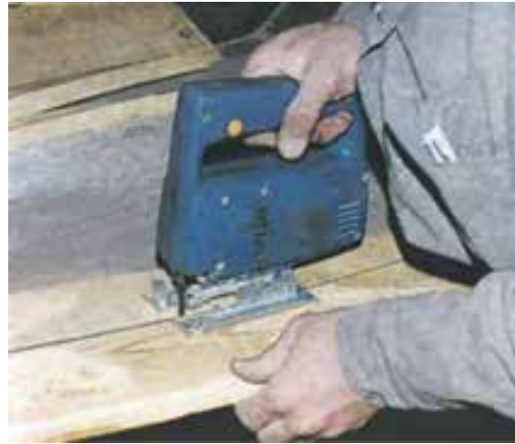
شکل ۱۵-۱۹- برش طولی چوب بدون استفاده از گونیا.
