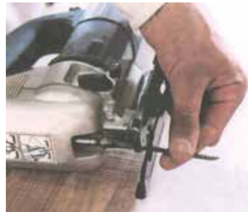
شکل ۱۵-۴۱- تعویض تیغه اره.
