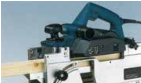
شکل ۱۴-۲۲- گندگی کردن چوب با استفاده از میز کمکی.
