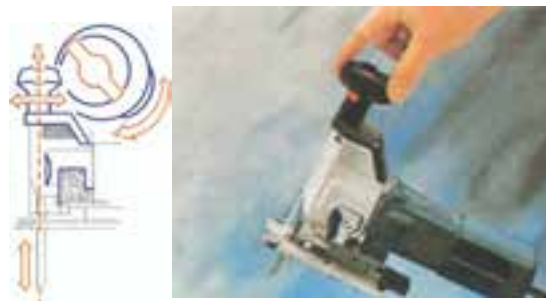
شکل ۱۵-۴۲- تعویض تیغه اره.
