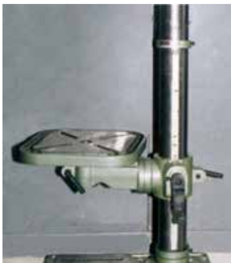
شکل ۱۹-۱۴- صفحه‌ی متمرک دریل ستونی.
