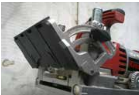
شکل ۴-۱۷- گونیا‌ی یک دستگاه فرز بیسکویتی.
