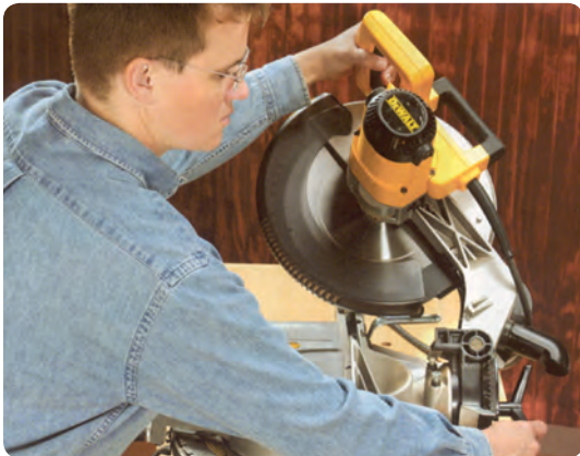
شکل ۲-۹ تنظیم زاویه چرخش اره گرد
