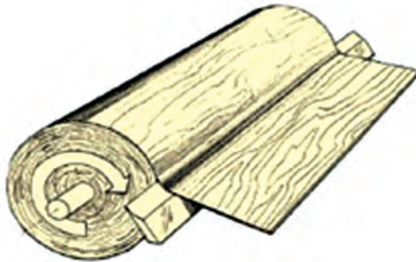
شکل ۱-۲۰ تهیه روکش به روش لوله‌بری
