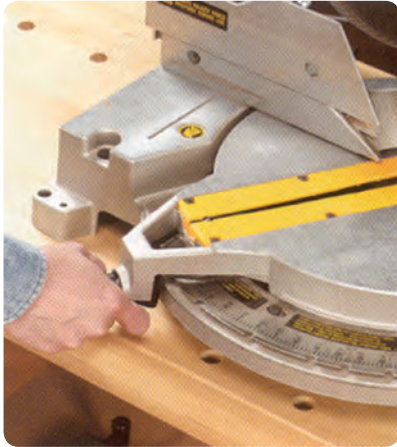
شکل ۲-۸ تنظیم زوایای مختلف برش
