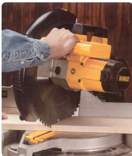
شکل ۲-۵ حرکت اهرمی در اره گرد فارسی بر
