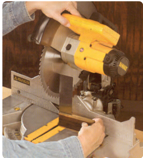
شکل ۲-۷ تنظیم عمود بودن تیغه پشت به صفحه
