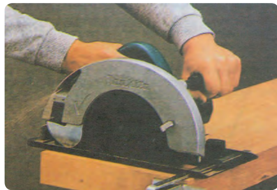
شکل ۲-۳۶ برش به وسیله گونیای دستگاه
