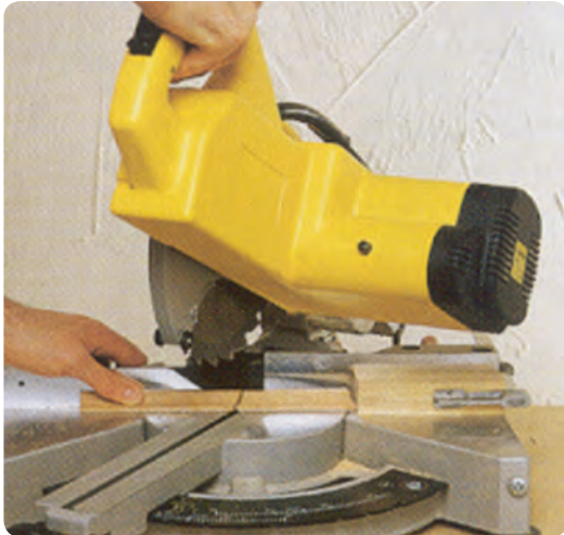
شکل ۲-۱۲- برش قائم با اره گرد فارسی بر
