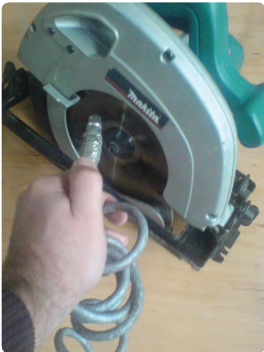
شکل ۲-۲۵ تمیز کردن دستگاه با هوای فشرده پمپ باد
