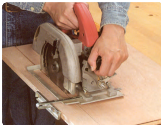
شکل ۲-۲۲ برش عرضی با گونیای ماشین
