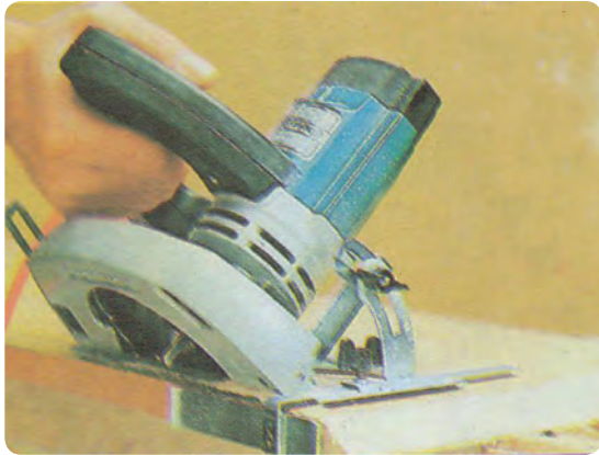
شکل ۲-۳۷ برش تحت زاویه به وسیله گونیای دستگاه
