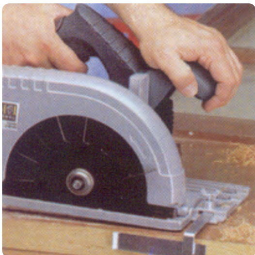
شکل ۲۰-۲ بکارگیری اره گرد دستی برقی
