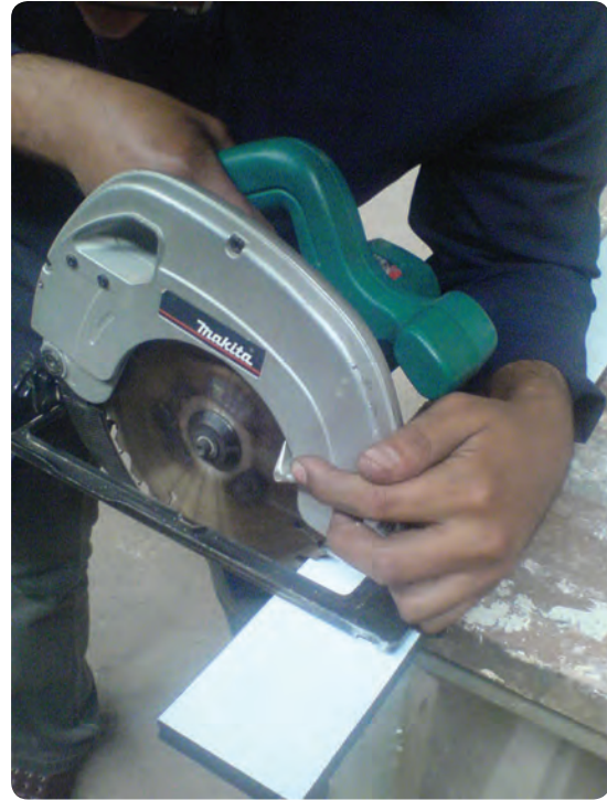
شکل ۲۸-۲ بیانگر رعایت نکردن اصول ایمنی در برش قطعه کار بدون بکارگیری گونیا یا بر راستی است
